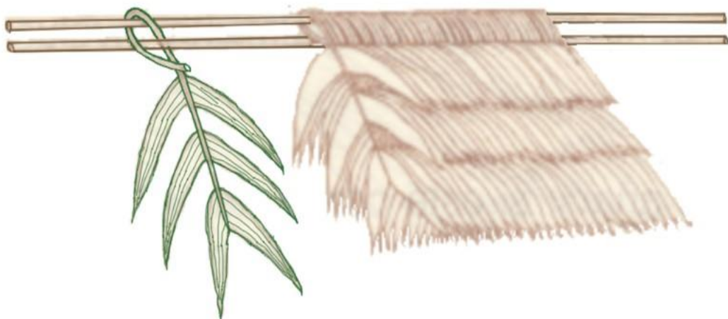
Figura 2. Armado y amarrado de un paño con hojas de palmiche elaborado en Bolivia.
