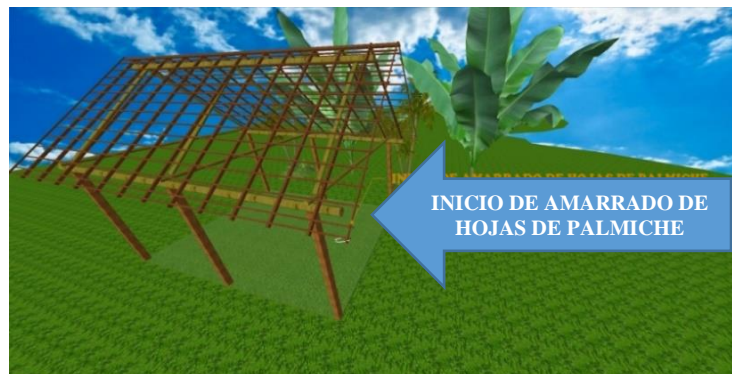
Figura 35. Estructura para la cubierta de palmiche.
