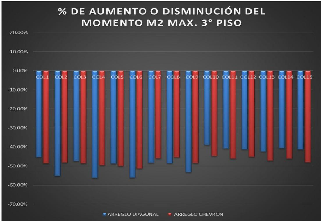
Figura 65. Porcentaje de aumento o disminución del momento M2 máximo en columnas usando disipadores en el 3° piso.
