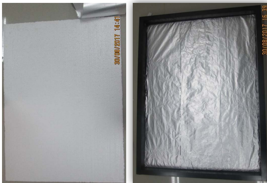
Fotografía 3. Plancha de tecnopor forrado con papel aluminio en la base del marco del colector solar.
