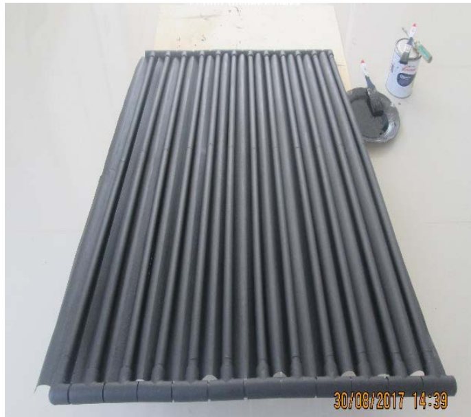
Fotografía 7. Calamina y tubos verticales de PVC pintados con esmalte negro mate.
