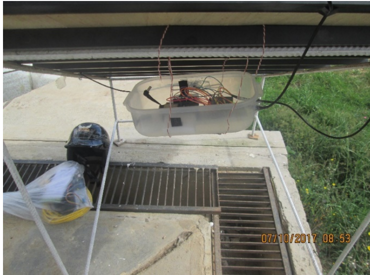
Fotografía 10. Sistema de adquisición de datos de temperatura ubicado debajo del colector solar.
