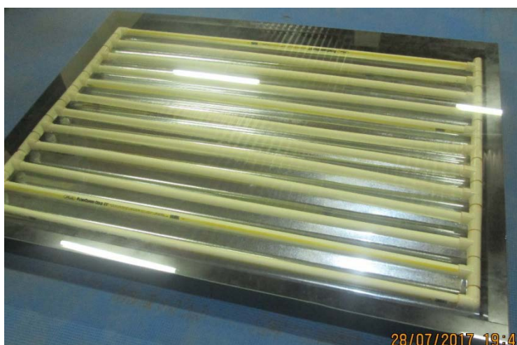
Fotografía 6. Ensamble y acople completo en el armazón de aluminio.
