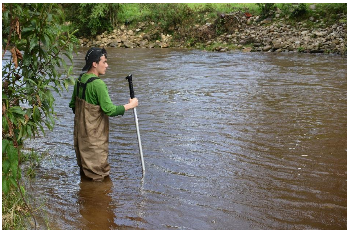
Figura 15. Medida de la velocidad de corriente con correntómetro
