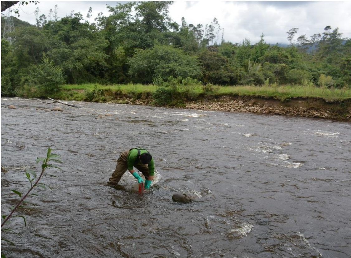
Figura 11. Muestreo de macroinvertebrados en la microcuenca del río Ventilla
