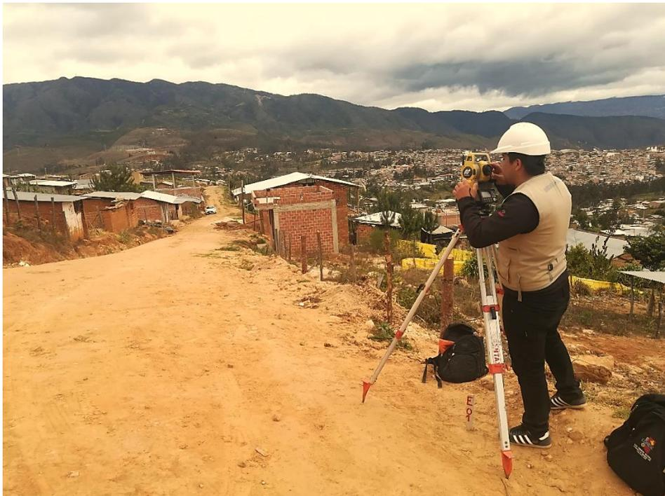
Levantamiento topográfico global
