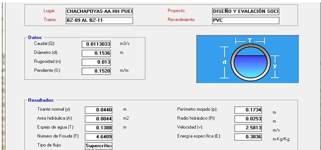
Figura 27. Características hidráulicas. Software: H Canales
