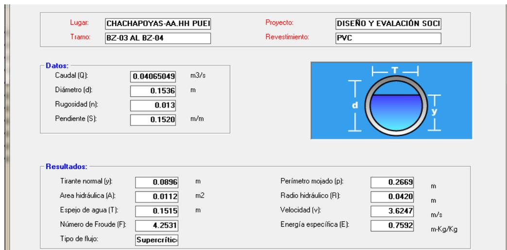
Figura 23. Características hidráulicas. Software: H Canales
