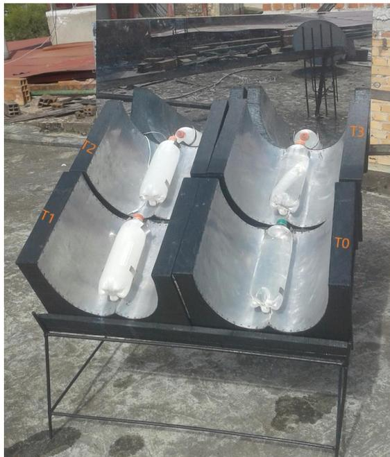
**Figura 19.** Experimento de desinfección de agua de pozo con los tratamientos: T0 (SODIS-CPC), T1 ( $\text{TiO}_{2\text{susp.}}$  – CPC), T2 (CI-CPC) y T3 (CII-CPC).
