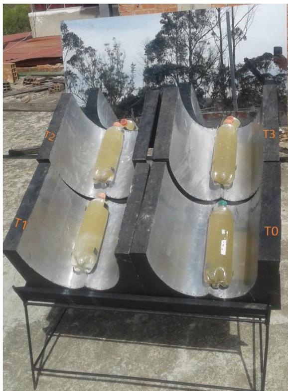
**Figura 20.** Experimento de degradación de materia orgánica de agua residual con los tratamientos: T0 (SODIS-CPC), T1 ( $\text{TiO}_{2\text{susp.}}$  – CPC), T2 (CI-CPC) y T3 (CII-CPC).
