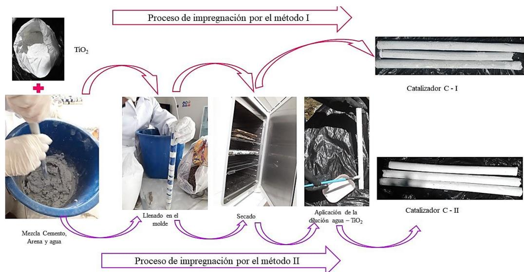
**Figura 14.** Impregnación de TiO<sub>2</sub> en concreto
