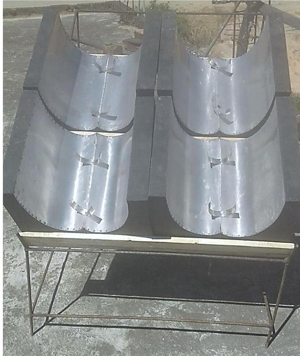
**Figura 18.** Instalación de los CPC 1.15 X sobre el soporte.
