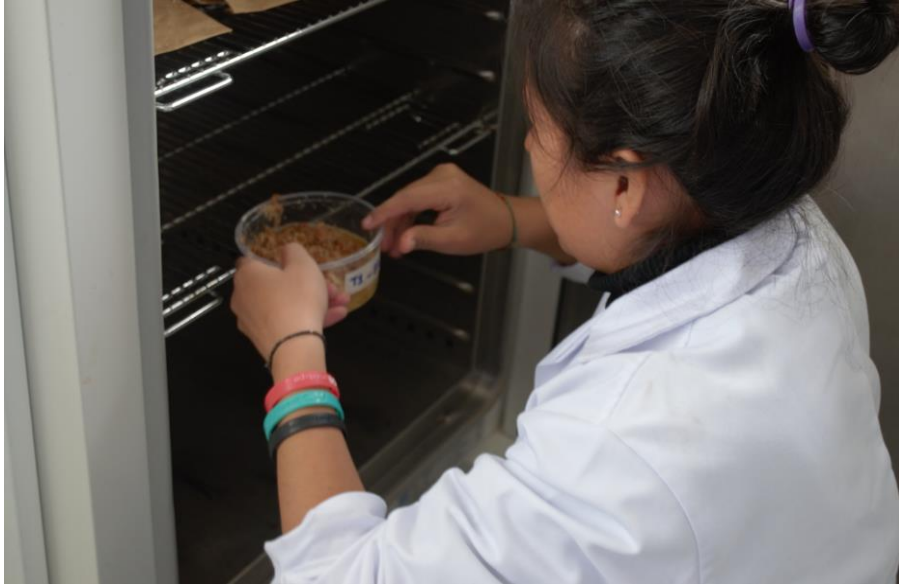
Foto N° 19: Colocación de muestras de tuberculos en la estufa para su secado a una temperatura de 60° (20/06/2016).
