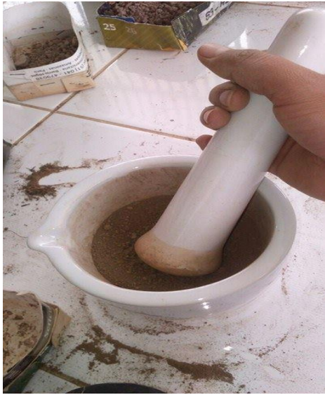
Foto N° 24 y 25: Muestra de suelo y tubérculo triturado en un mortero con la ayuda de un pilón (28/06/2016).
