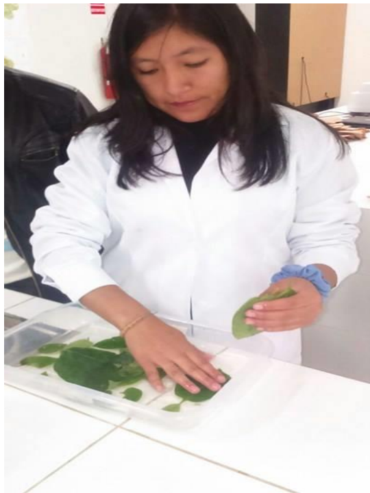
Foto N° 20: Lavado de muestra de hojas de la planta de papa con agua destilada (20/06/2016)
