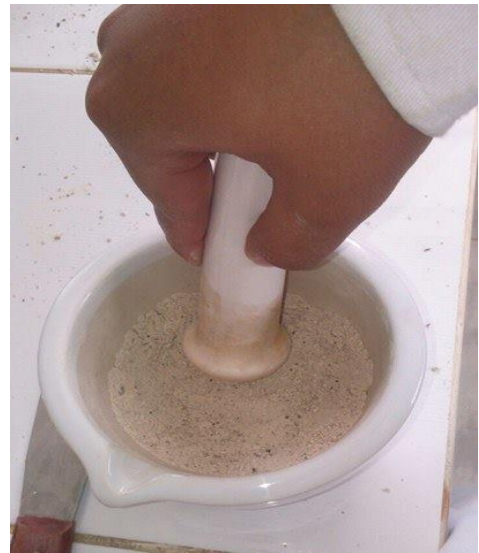
Foto N° 24 y 25: Muestra de suelo y tubérculo triturado en un mortero con la ayuda de un pilón (28/06/2016).
