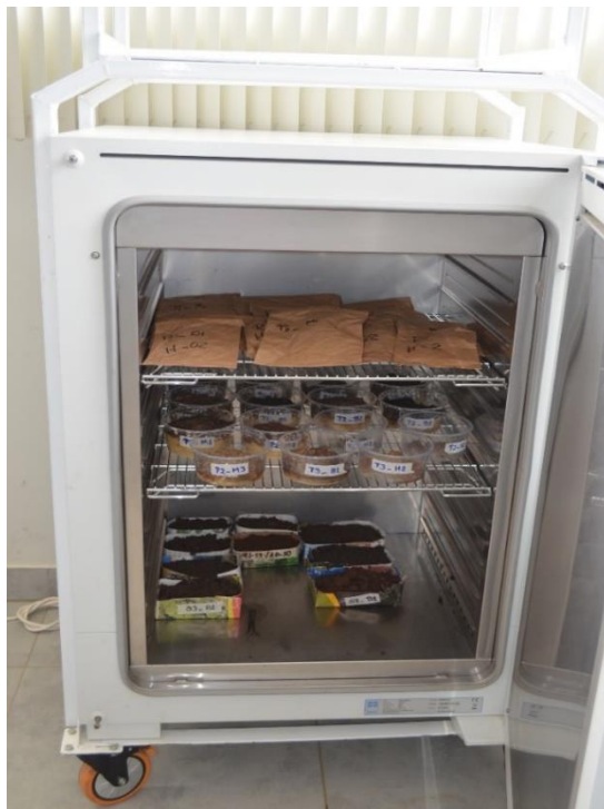
Foto N° 23: Muestras de suelo, hoja y tubérculo colocadas en la estufa para su secado a temperatura de 60° (20/06/2016).
