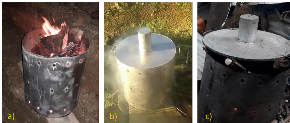
**Figura 12.** Proceso de la pirólisis a) Inicio de fuego. b) Liberación del contenido de humedad. c) Liberación de flama azul.
