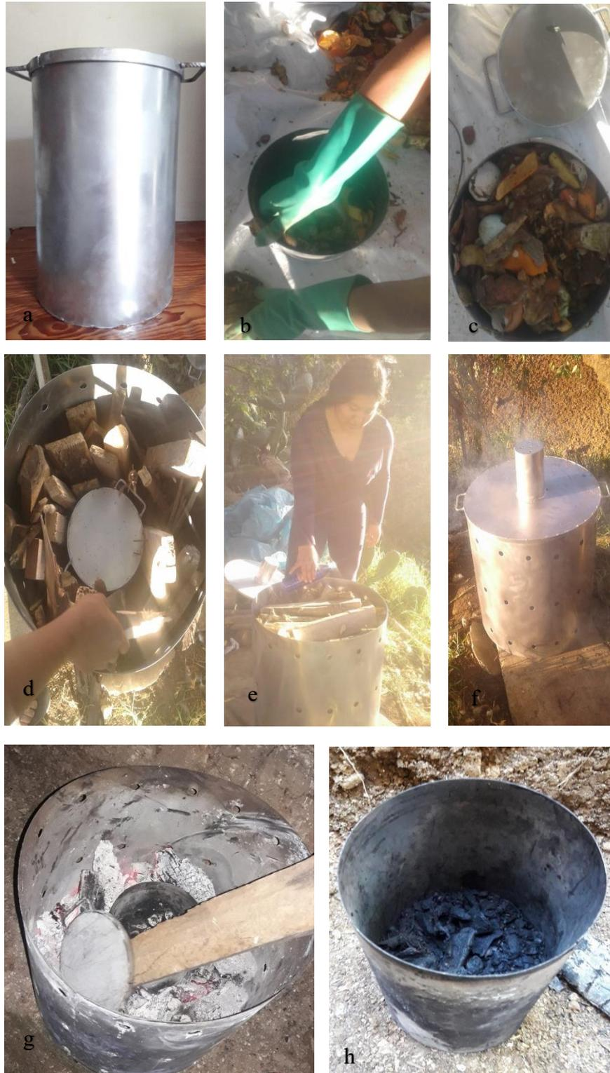
**Figura 6.** Producción de biochar. a) Acondicionamiento del tambor interno. b) y c) Llenado de la cámara interna con materia orgánica. d) y e) Acondicionamiento con leña en el espacio entre las dos cámaras. f) Inicio de llama, cierre del dispositivo e inicio del proceso de pirólisis. g) Monitoreo del tambor interno cese a la producción de biochar. h) Extracción de la cámara interna.
