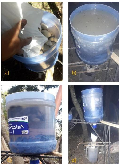
**Figura 10.** Aplicación del tratamiento de agua residual. a) Preparación del filtro. b) Agua residual en el filtro. c) Tratamiento del agua residual. d) Obtención de la muestra del agua residual.
