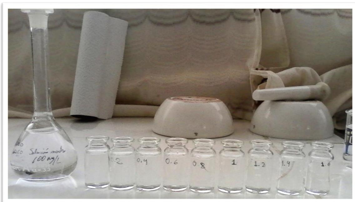
Figura 18. Viales con concentración de ácido gálico para crear una curva de calibración.
