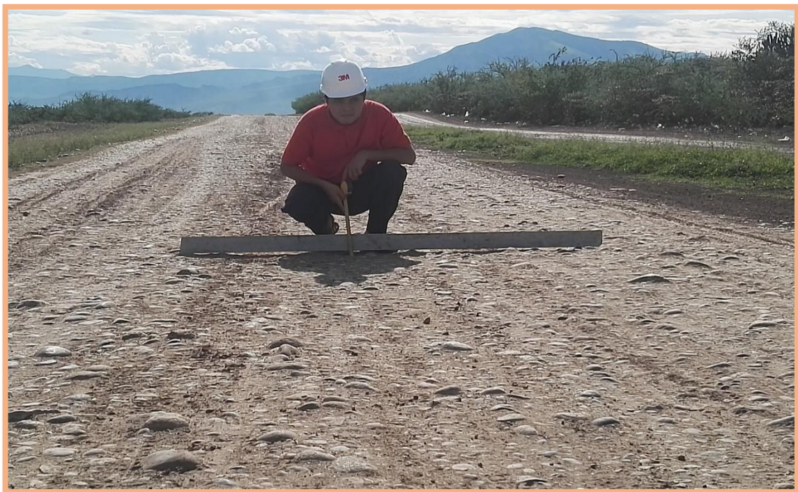
Figura 64: Sección N°2 (0.5-1km). Falla de deformación, encontrado desde el 630m hasta 1km, según Tabla 2, menciona que es de gravedad 1, huellas sensibles al usuario, pero <5cm.
