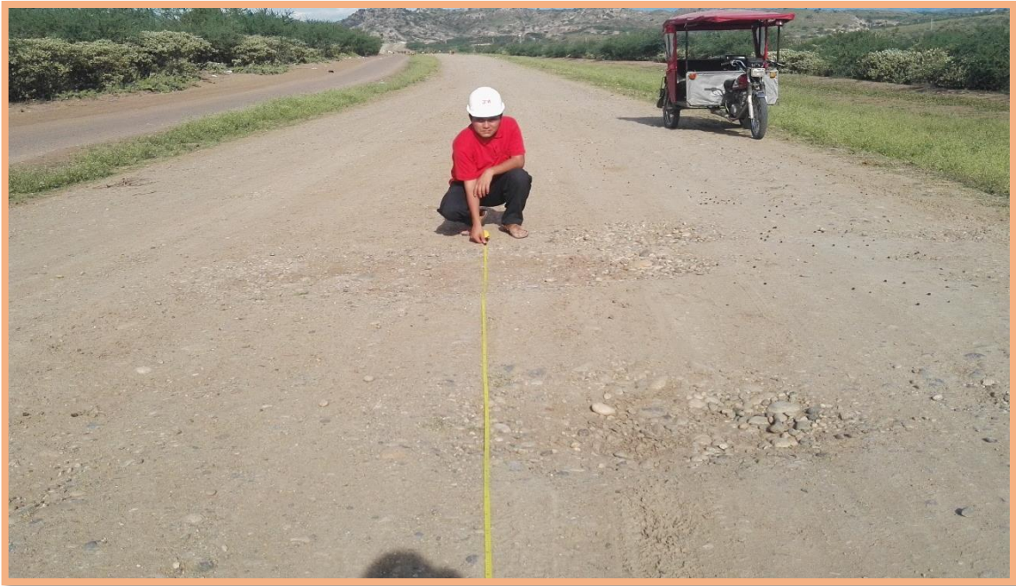
Figura 118: Unidad de Muestra N°3 (1.130km-1.185km). Inicio de la Unidad de Muestra N°3, midiendo la longitud de 55m respectivo, considerando el ancho de la calzada de 5.50m (Figura 48), cumple con el área estipula en la técnica de 302.5 \text{ m}^2
