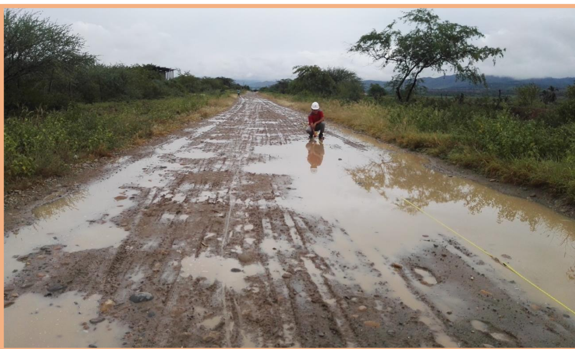
Figura 147: Unidad de Muestra N°8 (3.540km-3.590km). Inicio de la Unidad de Muestra N°7, midiendo la longitud de 50m respectivo, considerando el ancho de la calzada de 6.00m (Figura 94), cumple con el área estipula en la técnica de 300.0\text{ m}^2
