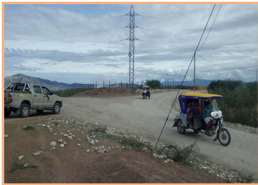
Figura 47: Punto N.º 1 de conteo vehicular. Mototaxi Honda también ha sido considerado para nuestro conteo, que será convertido equivalente peso a auto, ya que es un vehículo ligero y no está considerado en el formato de conteo MTC (por no ser típico).
