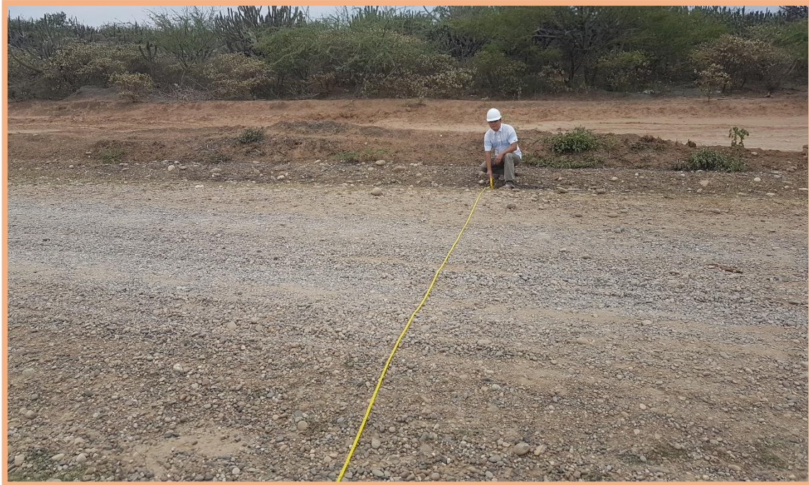
Figura 71: Sección N°4 (1.5-2km). Medición del ancho de la calzada, dando 5.50m de longitud.
