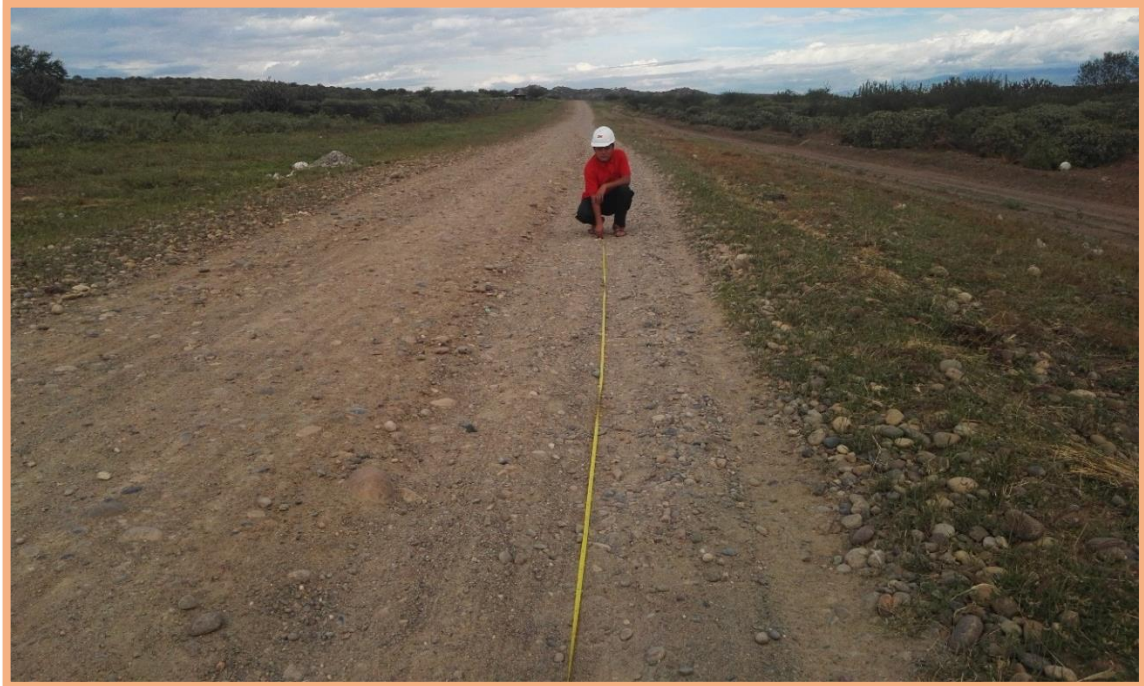
Figura 124: Unidad de Muestra N°4 (1.321km-1.376km). Inicio de la Unidad de Muestra N°4, midiendo la longitud de 55m respectivo, considerando el ancho de la calzada de 5.50m (Figura 48), cumple con el área estipula en la técnica de 302.5 m 2
