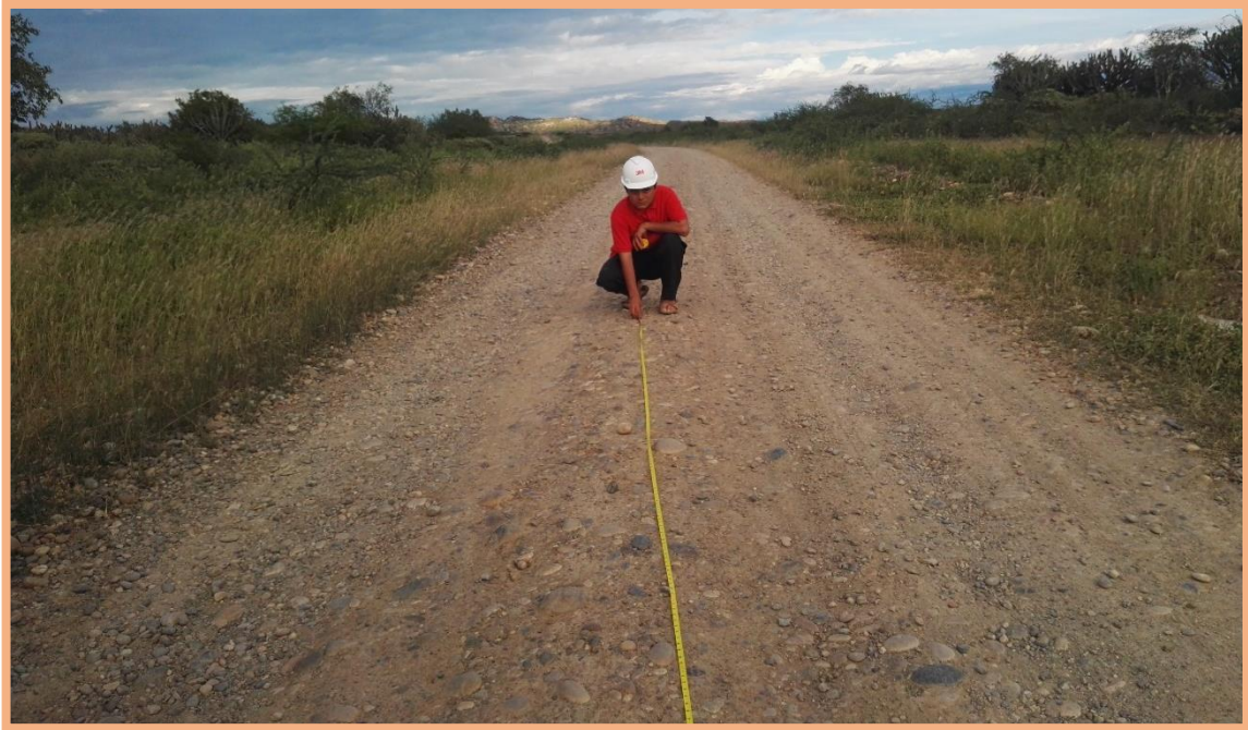
Figura 130: Unidad de Muestra N°5 (2.315km-2.370km). Inicio de la Unidad de Muestra N°5, midiendo la longitud de 55m respectivo, considerando el ancho de la calzada de 5.50m (Figura 70), cumple con el área estipula en la técnica de 302.5 \text{ m}^2
