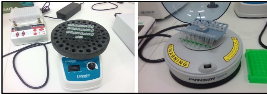
Figura 8. Vortex (para mezcla de componentes de PCR) y centrifugado (spin)
