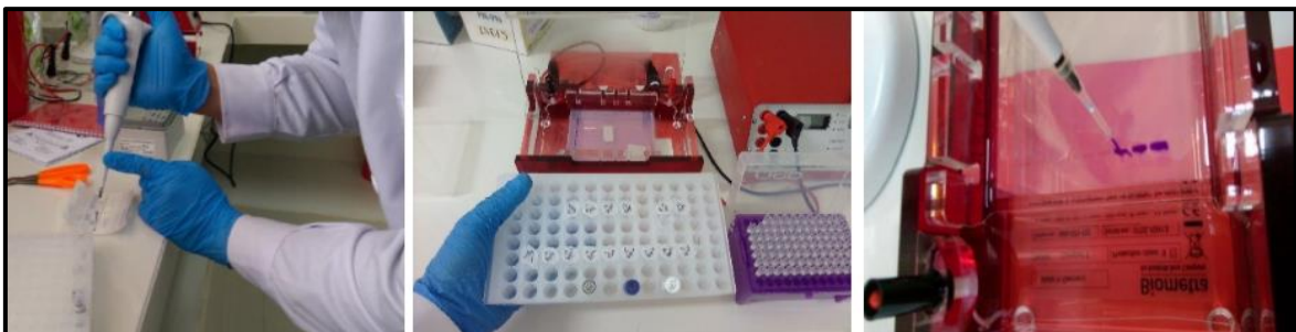
Figura 13. Mezcla del producto de la reacción con el tinte (Loading 6X) y su posterior puesta en el gel de agarosa
