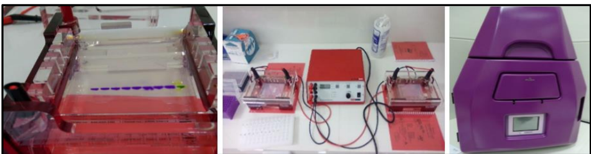
Figura 14. Mezcla de reacción más escalera (Ladder), electroforesis en gel por 45 minutos a 120 voltios y transiluminador genómico donde se verán las bandas generadas por la acción de las enzimas de restricción.
