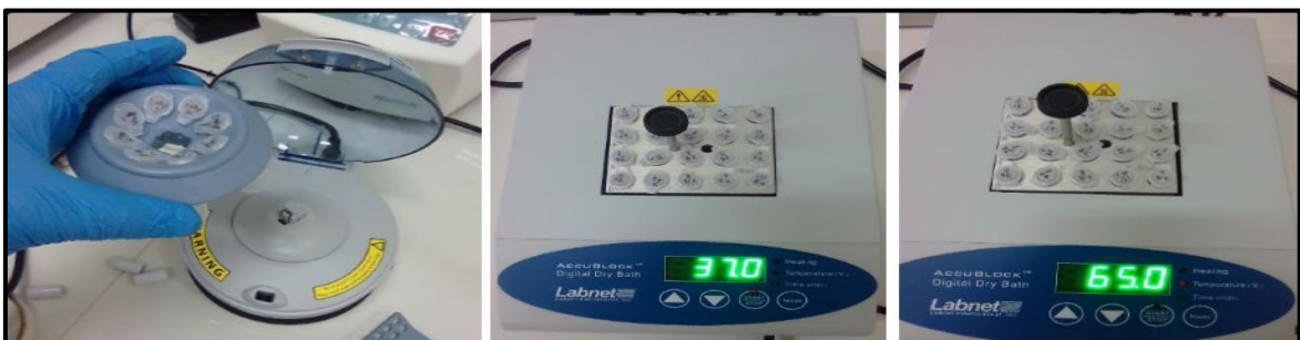
Figura 12. Centrifugado de la mezcla de reacción con la enzima AluI, incubación a 37°C por 100 minutos e inactivación a 65°C por 15 minutos
