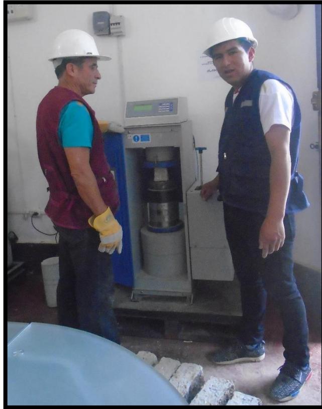
Figura 15. Ensayo de resistencia a compresión de los cubos de adobe.
