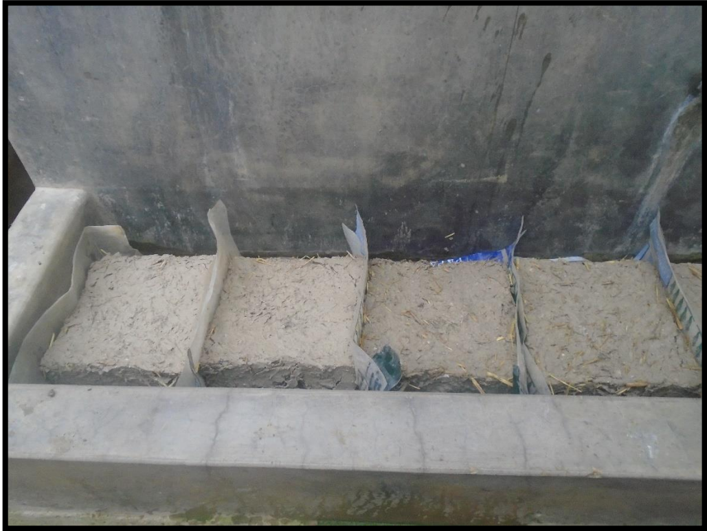
Figura 19. Muestras de adobe después de transcurrir 24 horas sumergidos en agua.
