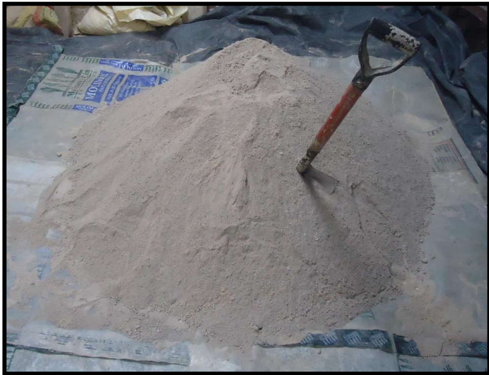
Figura 6. Mezcla de ceniza y arena para el mezclado con el barro.
