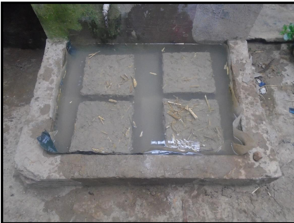
Figura 18. Muestras de adobe sumergidos en agua para el ensayo de absorción.
