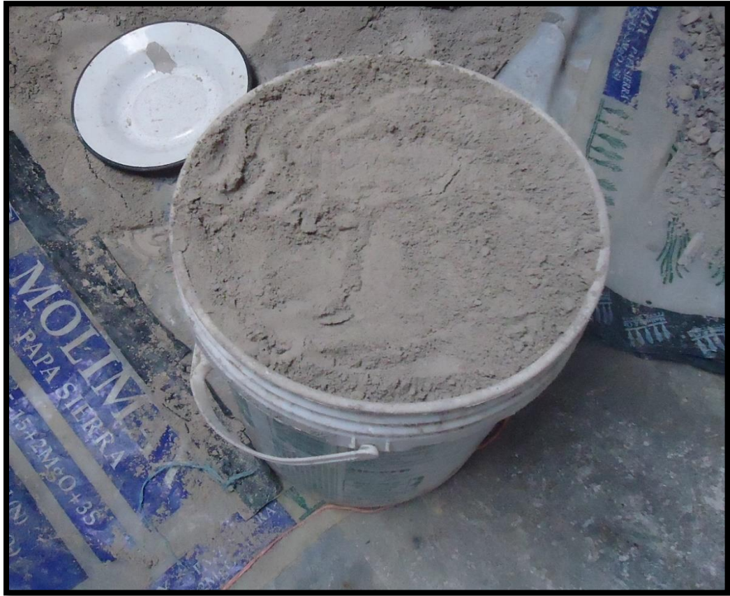
Figura 5. Ceniza zarandeada para el mezclado con el barro.
