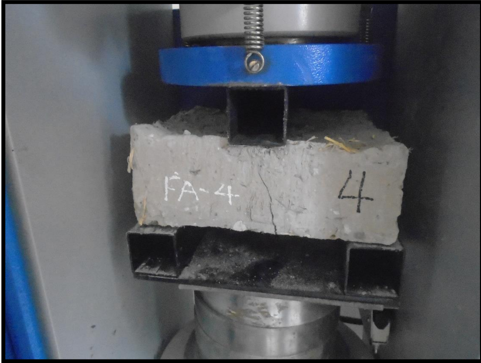
Figura 17. Ensayo de resistencia a flexión de las muestras de adobe.
