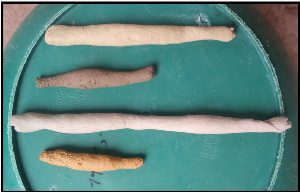
Figura 2. Prueba de “cintilla” o “rollito”
