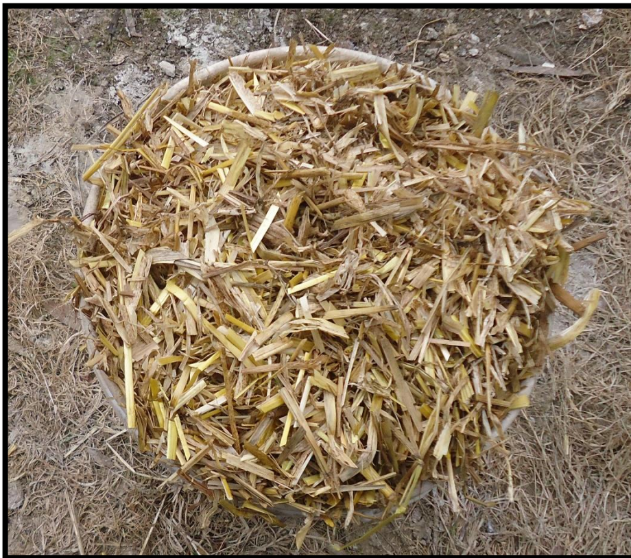
Figura 7. Cortado de paja para el mezclado con el barro.
