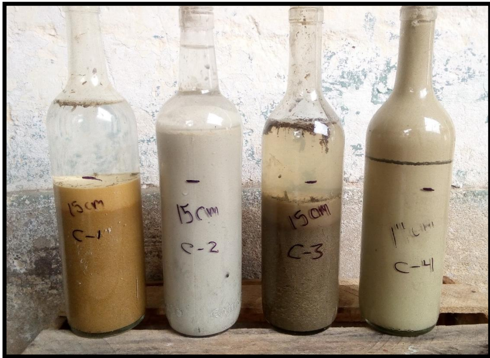
Figura 1. Prueba de “sedimentación”
