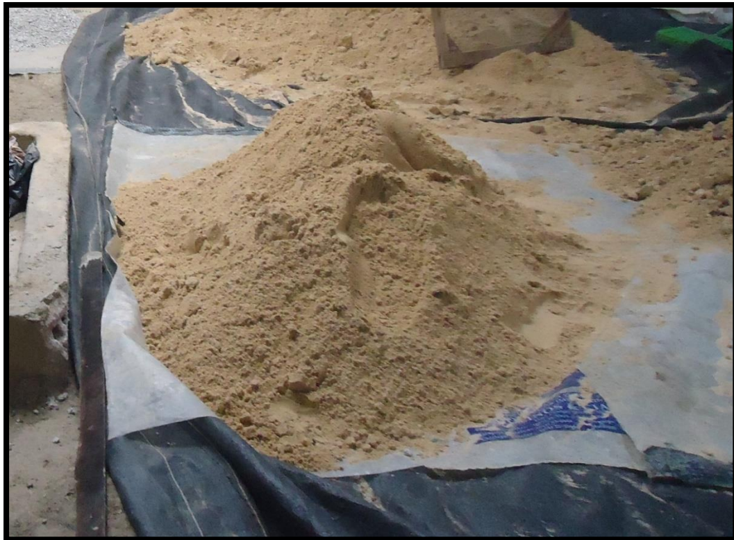
Figura 4. Arena fina zarandeada para el mezclado con el barro.
