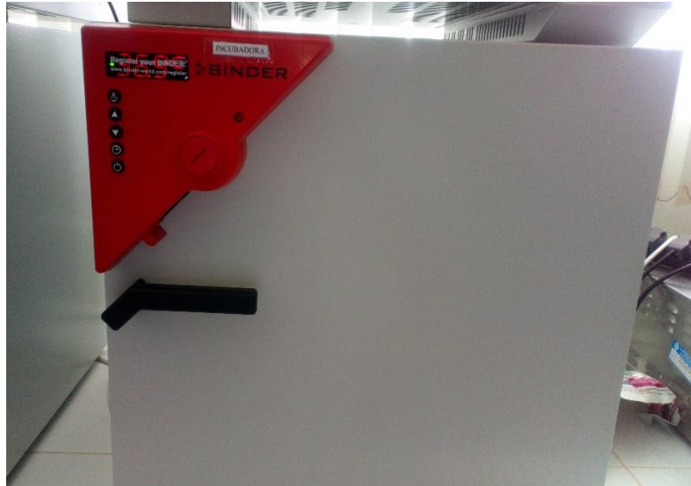
Figura 18. Incubación de los medios para lauril sulfato(presuntiva) se dio a 37°C; para EC (confirmativa) a 44°C y para EMB a 37°C
