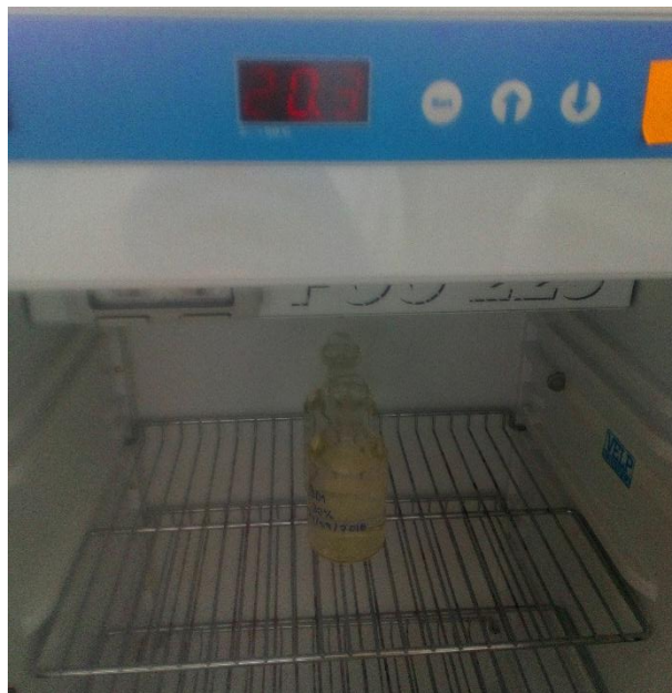
Figura 19. Incubación de la muestra de DBO durante 5 días a temperatura ambiente
