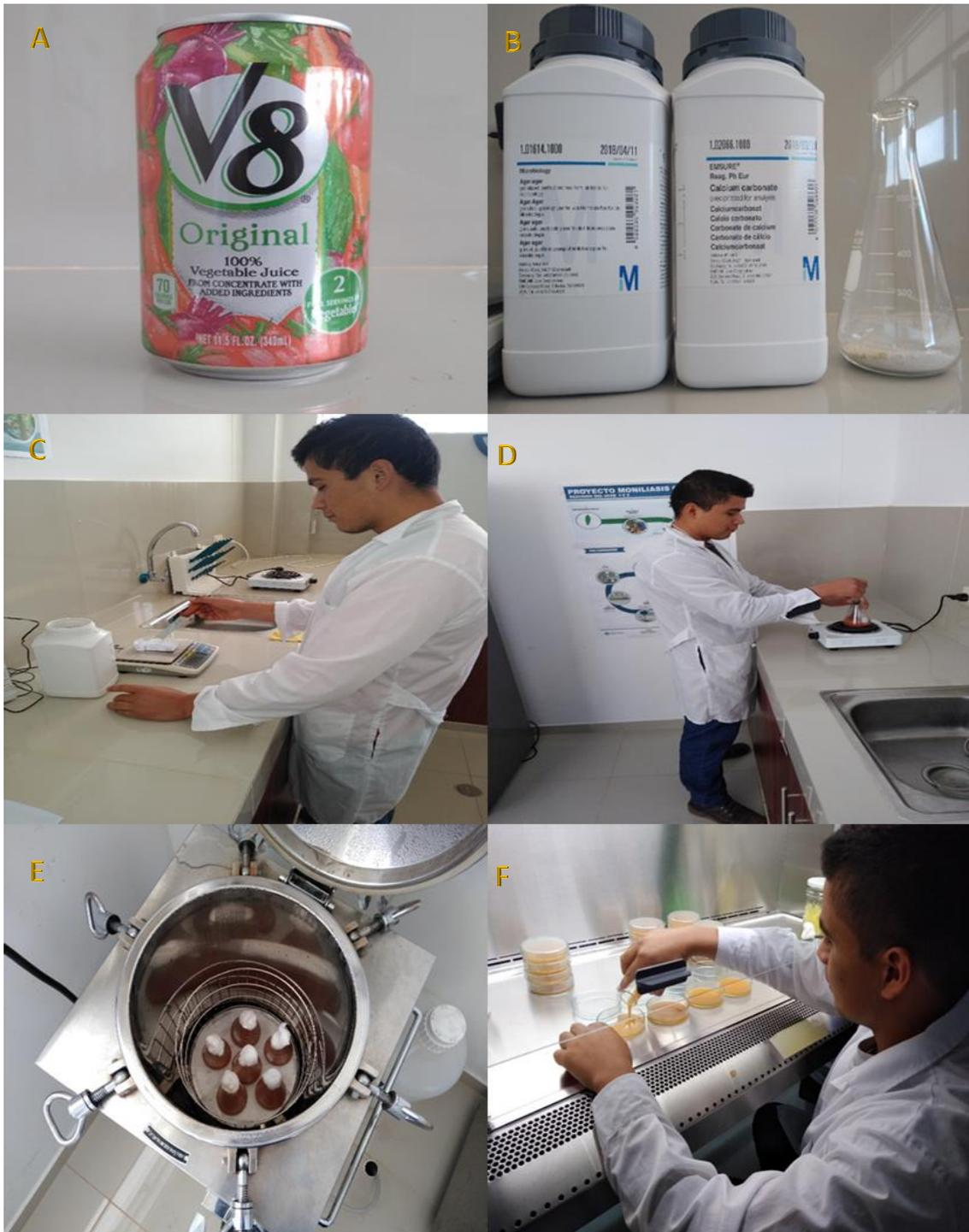
**Figura 12.** Preparación de medio de cultivo sólido V8. (A) Jugo de verduras V8; (B) Agar agar y carbonato de calcio ( $\text{CaCO}_3$ ); (C) Pesado de los insumos; (D) Disolución de la solución del medio de cultivo en una cocina eléctrica, (E) Autoclavado del medio de cultivo; (F) servido de las placas Petri con el medio de cultivo V8.
