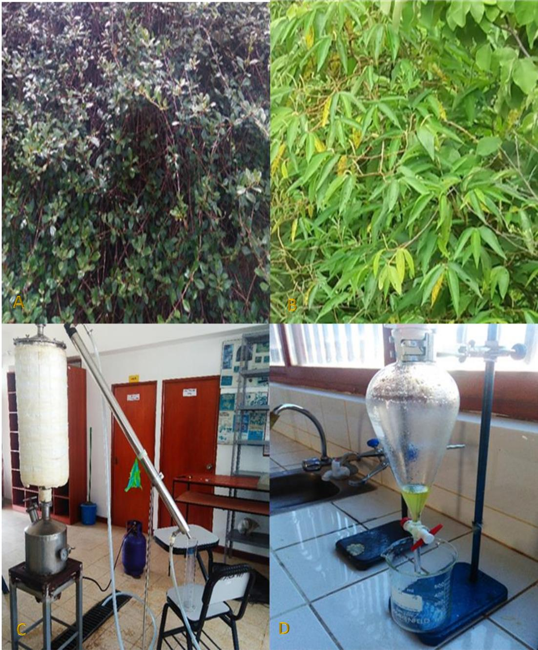
**Figura 11.** Destilado de aceites esenciales. (A) *Lippia* sp.; (B) *Piper aduncum*; (C) Proceso de destilado de arrastre de vapor; (D) Decantado del aceite esencial.
