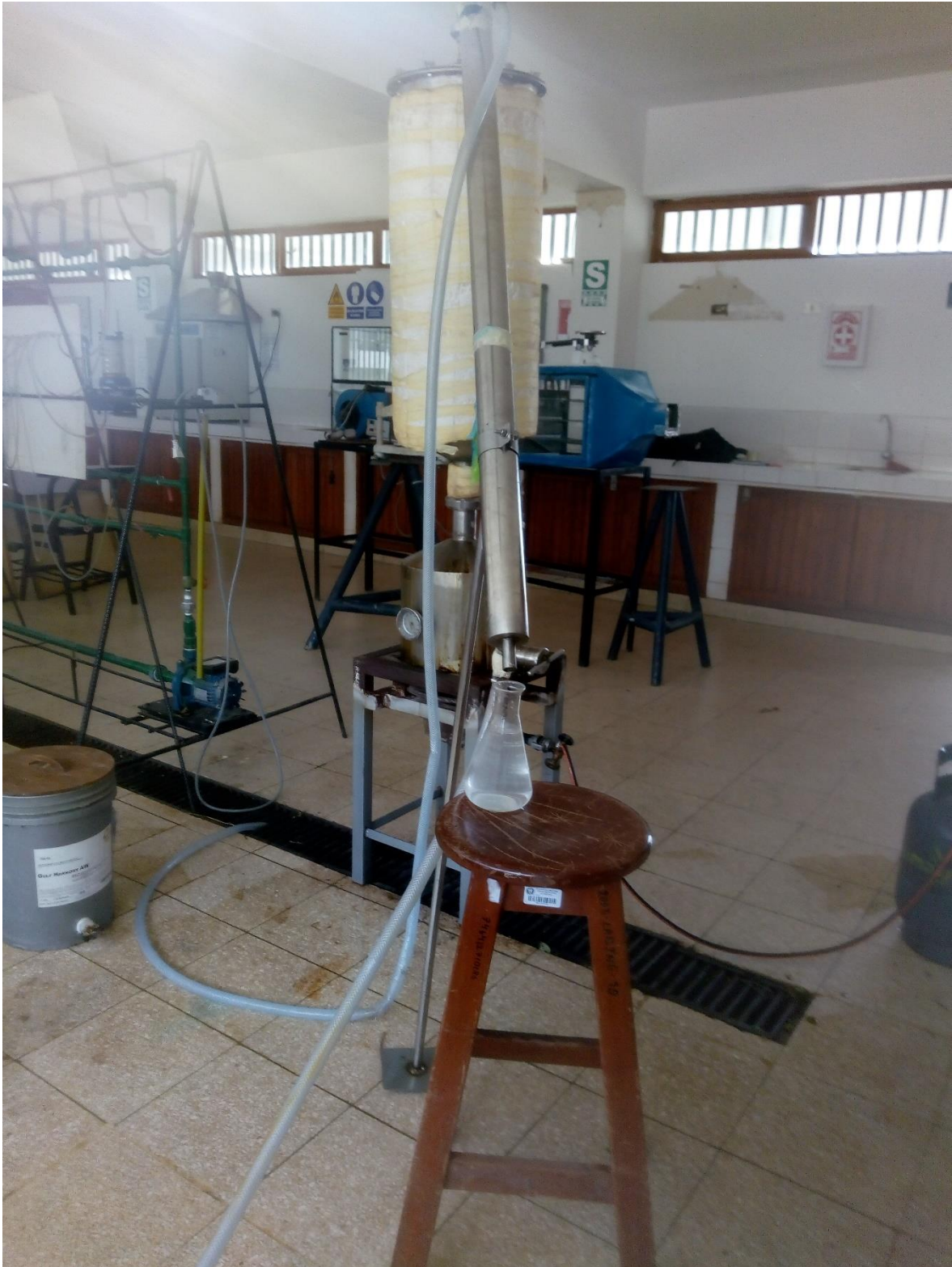
Figura 8. Extracción del aceite esencial de hojas y ramas de M. mollis por arrastre de vapor
