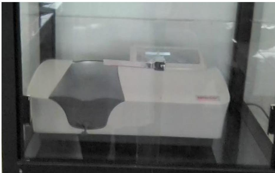
Figura 12. Espectrofotómetro UV vis para medir la absorbancia (técnica DPPH)
