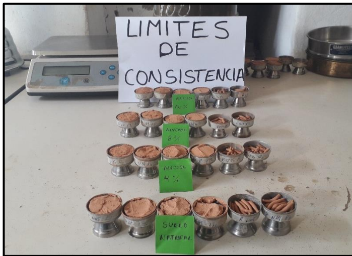
Imagen 8: Muestras para el análisis de límites de consistencia con sus respectivas adiciones de 4%, 8% y 12% de bolsas de polietileno fundido.
