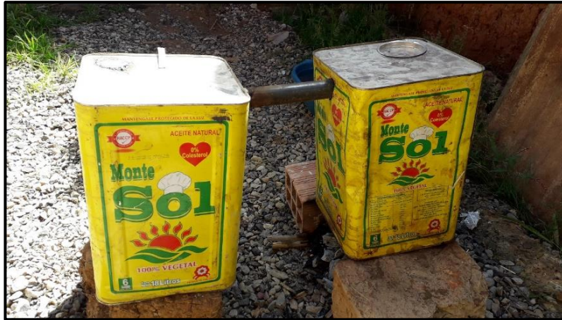
Imagen 4: Fundido de bolsas de polietileno en una máquina casera que consta de dos latas en una de las latas se encuentra bolsas de polietileno y la otra con agua para atrapar el humo cuando se realiza la combustión.
