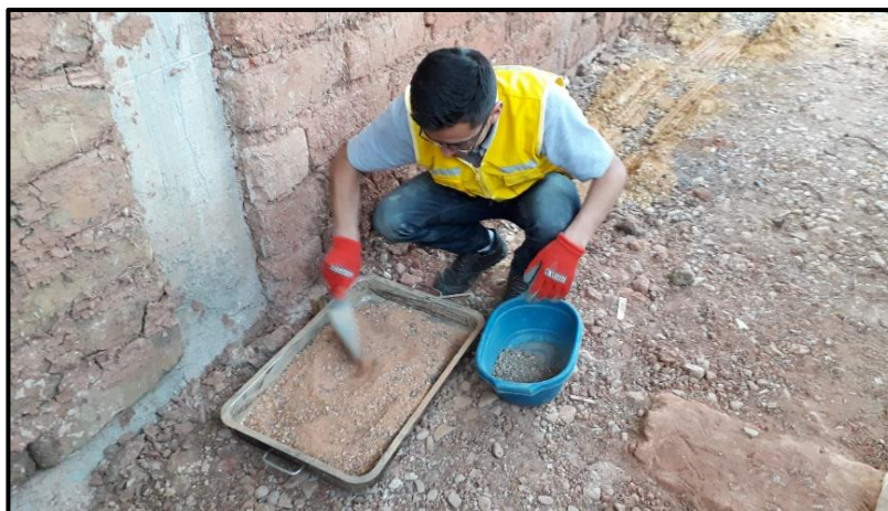
Imagen 6: Mezclando el material con adiciones de 4%, 8% y 12% con respecto al peso del suelo.
