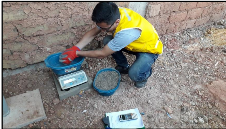
Imagen 5: Pesando las bolsas de polietileno fundido más el suelo seco en proporción 1:1 la cual fue tomada como adición de bolsas de polietileno fundido.
