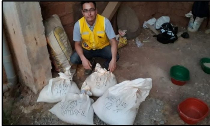
Imagen 7: Muestra de suelo natural y con sus respectivas adiciones de 4%, 8% y 12% de bolsas de polietileno fundido.
