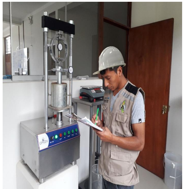
Figura 7. Lectura de la penetración en la máquina de CBR.
