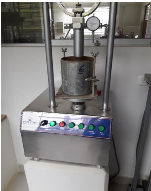
Figura 7. Lectura de la penetración en la máquina de CBR.
