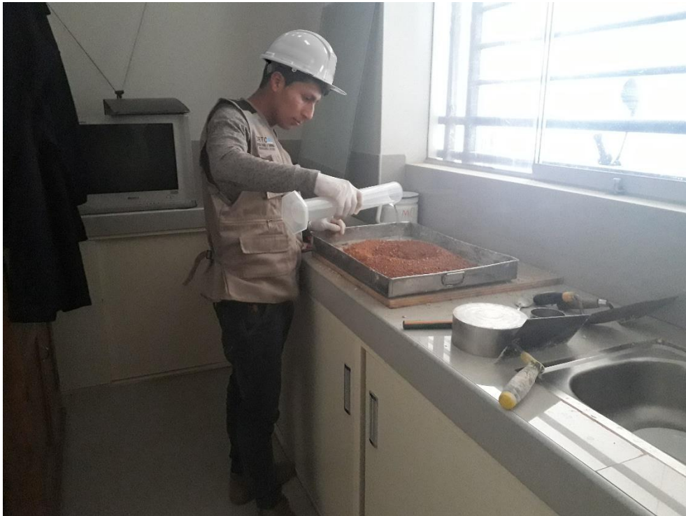
Figura 5. Preparación del material para el ensayo de compactación proctor estándar.
