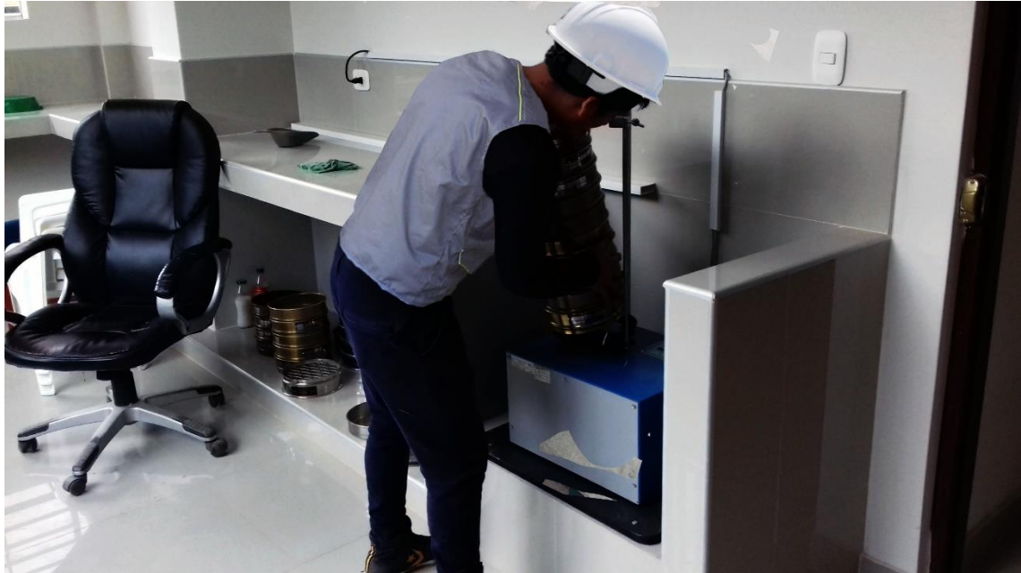
Figura 3. Ensayo de análisis granulométrico por tamizado.
