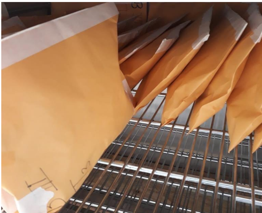
Fotografía 13. Colocación de muestras a la estufa
