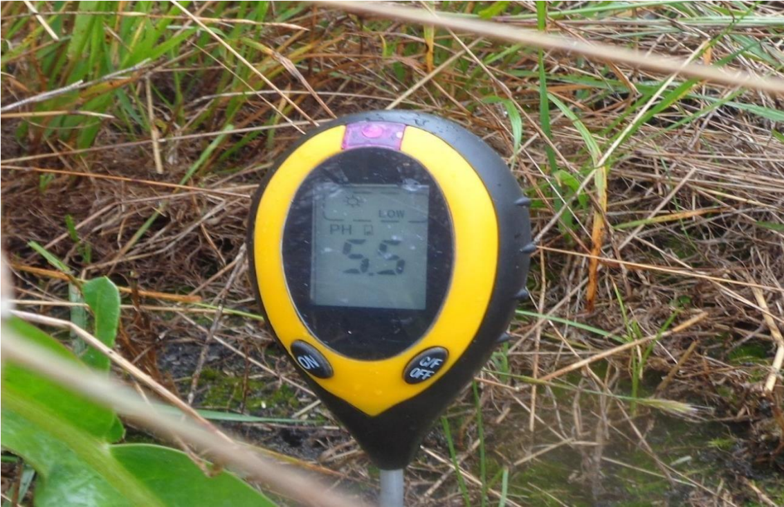
Fotografía 11. Medición del pH del suelo
