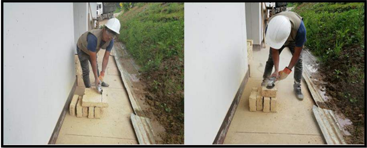
Preparación de probetas para ensayo de compresión simple.
