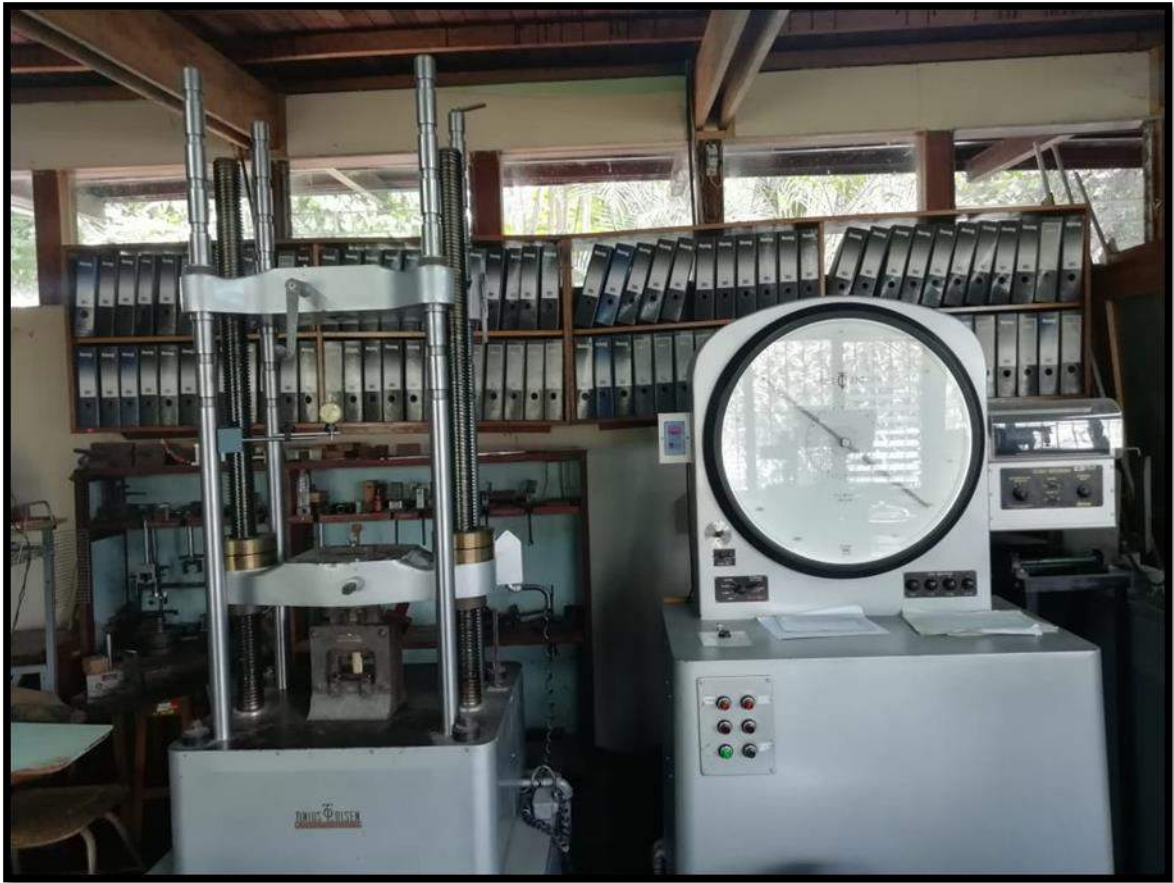
Maquina universal Laboratorio de Tecnología de la madera de la Facultad de Ciencias Forestales UNALM- Lima.
