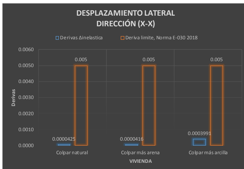
Figura 49.- Desplazamientos de entrepiso en la dirección X-X.
