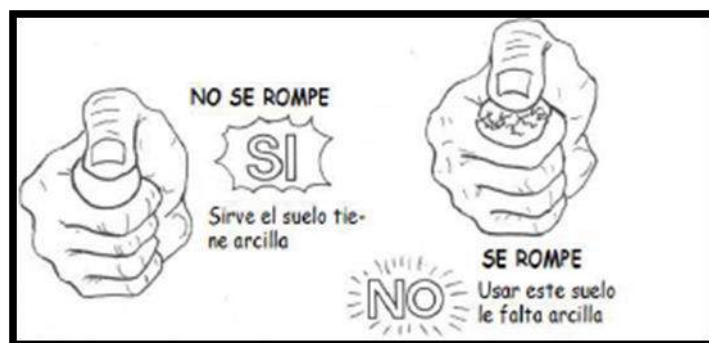
Figura 07.- Rotura de las bolitas de tierra.
