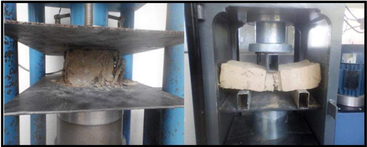
Ensayo de compresión simple y flexión simple de las muestras.
