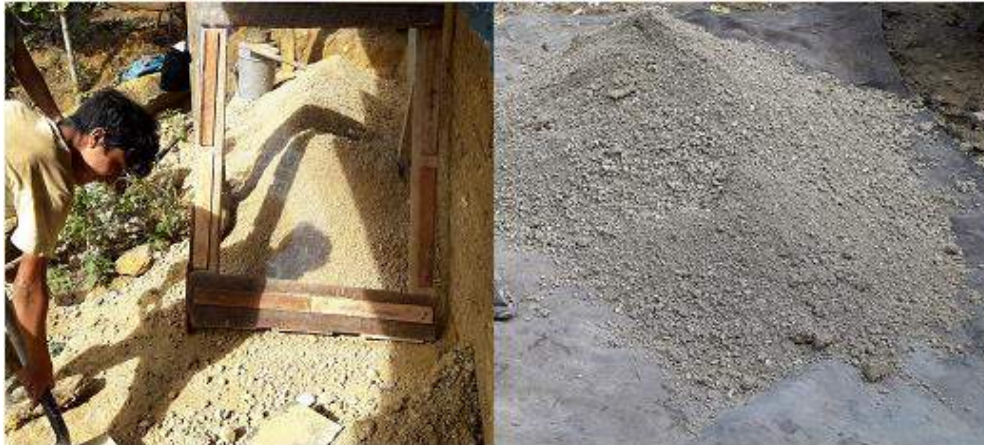
Figura 53.- Proceso de tamizado por la malla 3/4".
