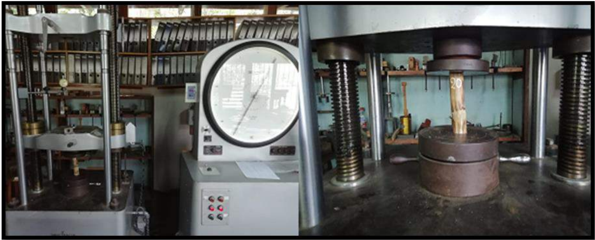
Figura 68: Ensayo de compresión paralela a las fibras Gynerium sagittatum (caña brava)
