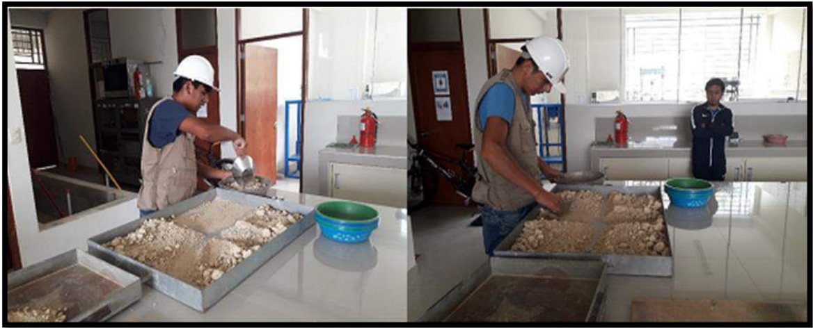
Proceso de cuarteo a las muestras de suelos, laboratorio MTC.
