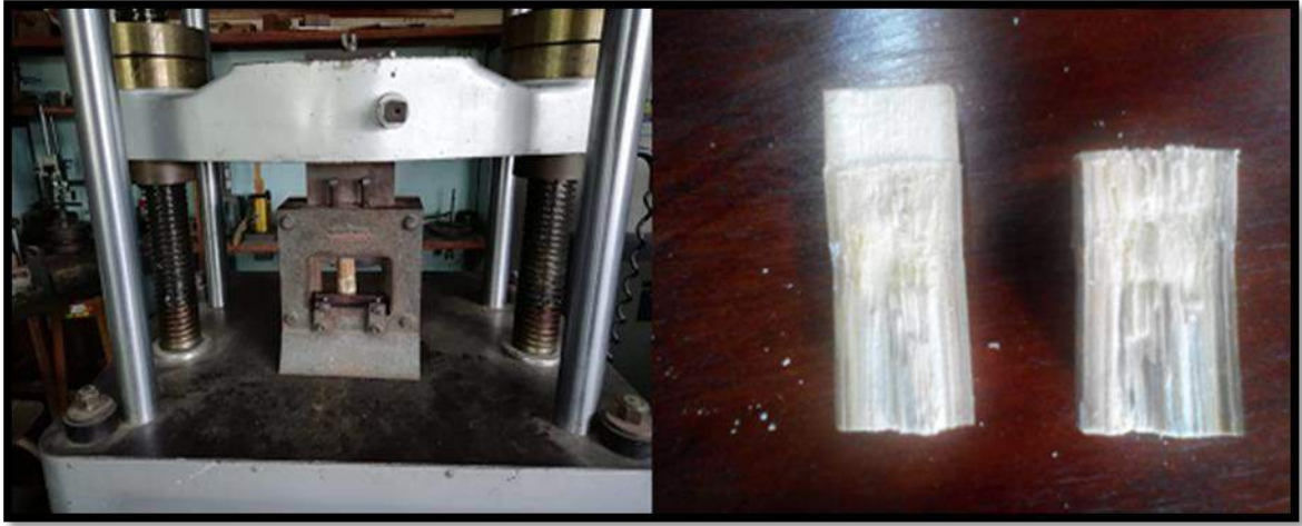
Ensayo de cizallamiento paralelo al grano Gynerium sagittatum (caña brava)
