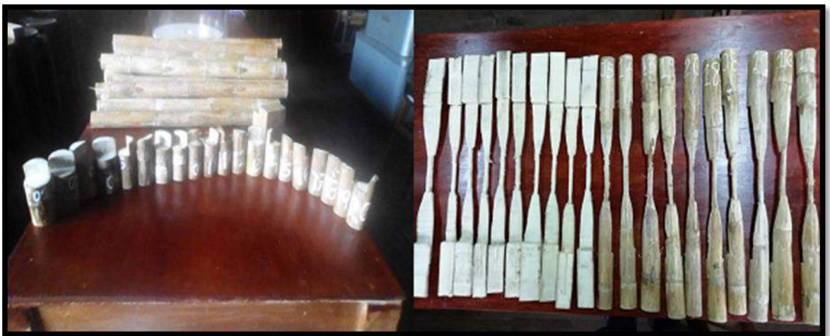
Habilitación de probetas para ensayos de cizallamiento y tracción paralela caña brava ( Gynerium sagittatum ).
