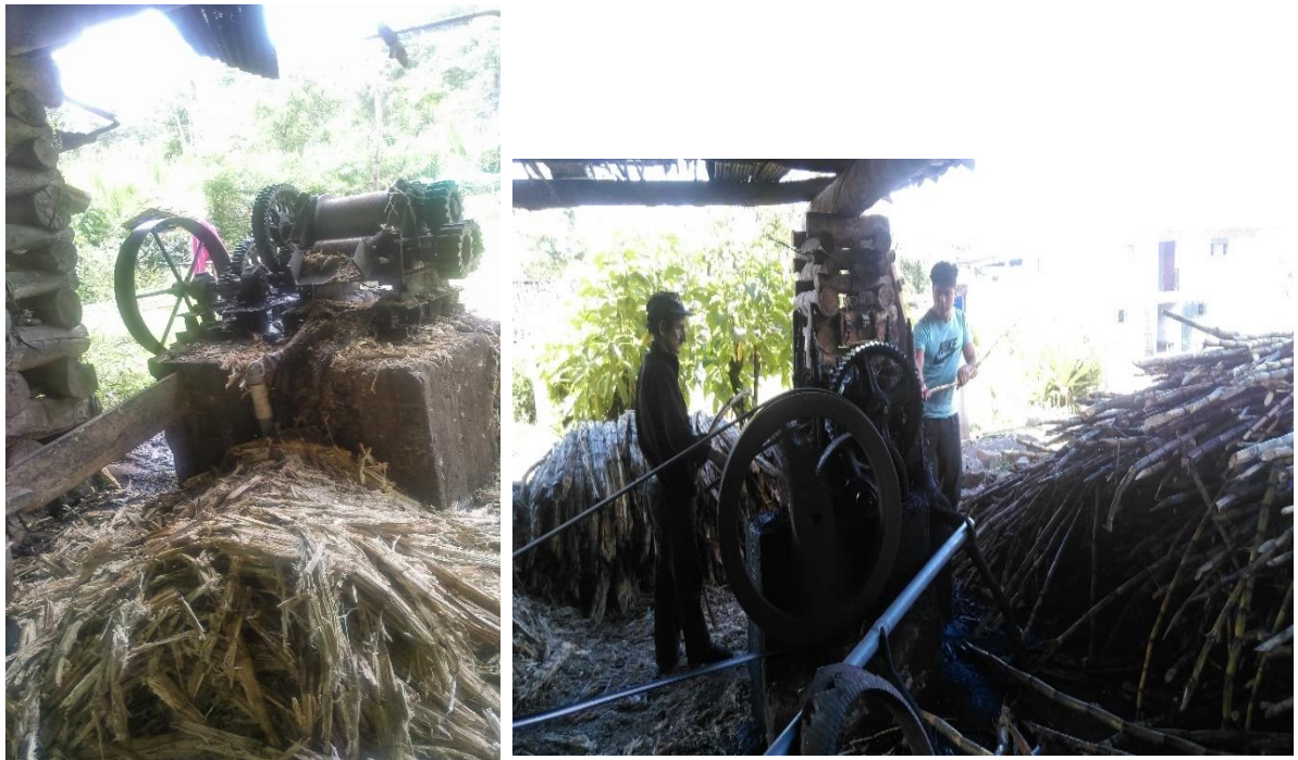
Figura 3 Trapiche a motor de tres cilindros de propiedad de don Juan de la Cruz Herrera Meléndez
