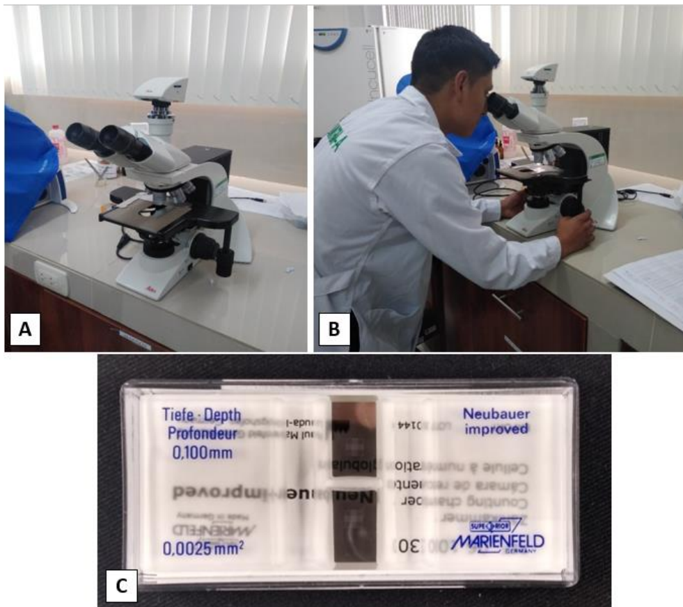
Figura 11. Conteo de esporas de las cuatro cepas de Tichoderma spp. en laboratorio. A: Microscopio de inflorescencia invertido. B: Conteo de esporas en los 5 cuadrantes. C: Cámara de Neubauer.
