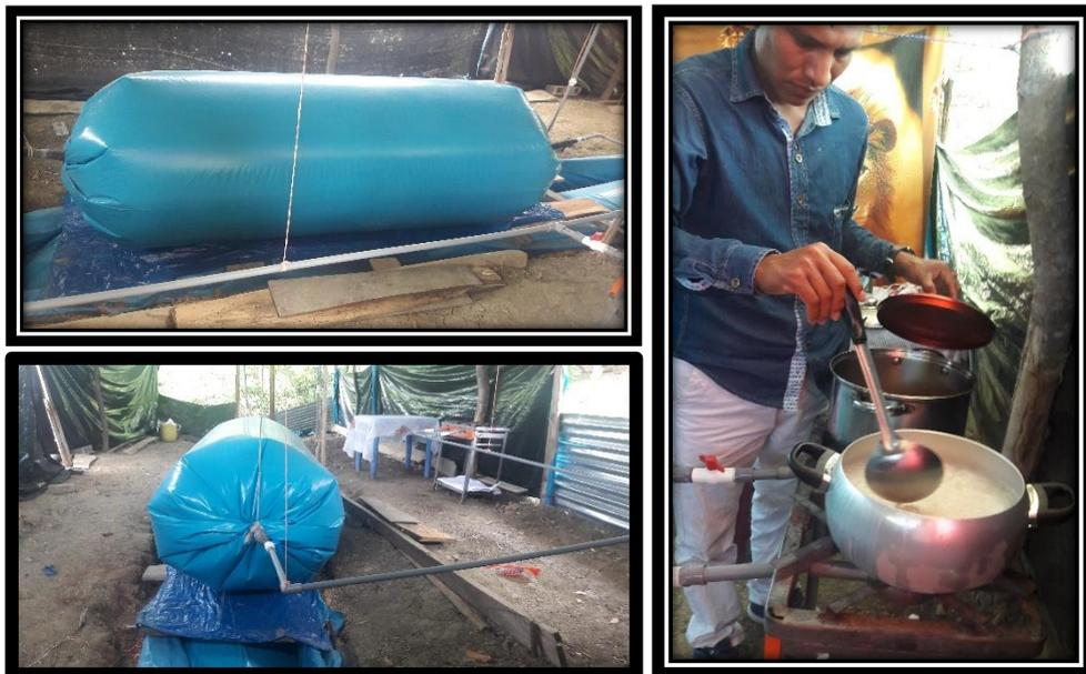
**Figura 16.** Gasómetro conectado a la cocina.
