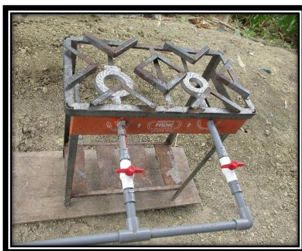
**Figura 12.** Cocina industrial adaptada para funcionar a biogás.
