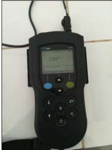
Figura 2: Multiparámetro usado para la medición de pH
