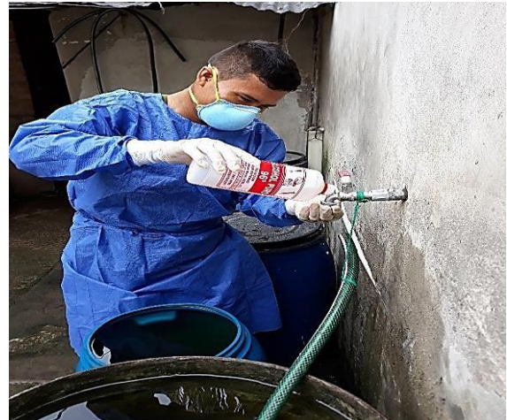
Figura 111: Desinfección del caño de conexión directa para el análisis microbiológico.
