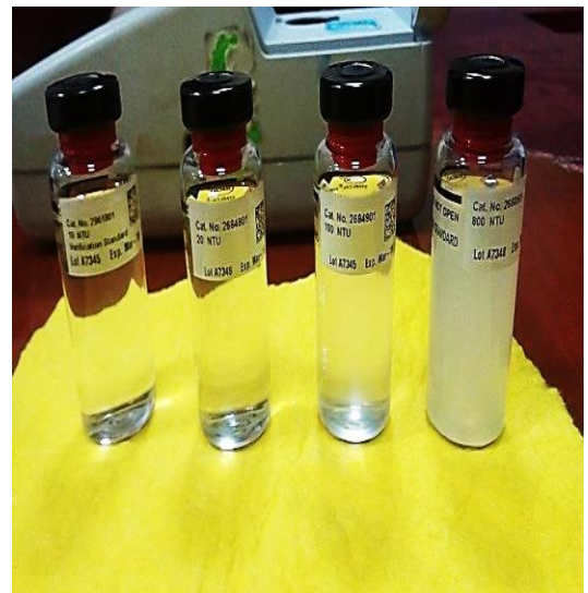
Figura 103: Calibración del Turbidímetro para el muestreo de campo por parte del responsable del programa de vigilancia de la calidad del agua para consumo humano-pvica- red de salud Bagua.
