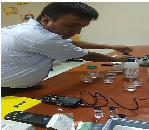
Figura 105: Calibración del Multiparámetro para el muestreo de campo por parte del responsable del Programa de Vigilancia De La Calidad Del Agua Para Consumo Humano-PVICA-Red De Salud Bagua.
