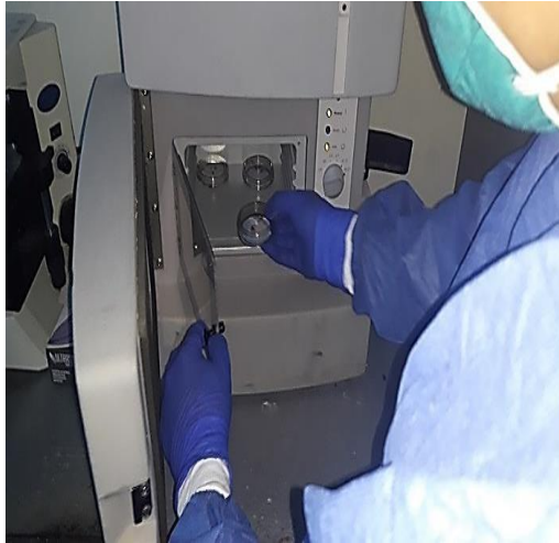
Figura 116: Incubación de las muestras procesadas para coliformes totales y coliformes fecales por el responsable del laboratorio referencial
