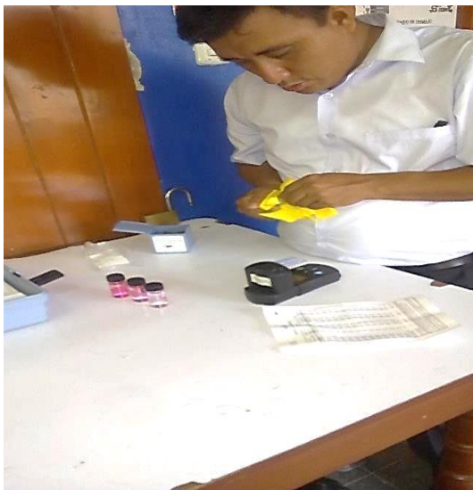
Figura 101: Calibración del Colorímetro para el muestreo de campo por parte del responsable del programa de vigilancia de la calidad del agua para consumo humano-pvica-red de salud Bagua.
