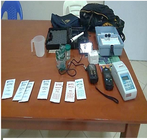
Figura 104: Calibración del Multiparámetro para el muestreo de campo por parte del responsable del programa de vigilancia de la calidad del agua para consumo humano-pvica-red de salud Bagua.
