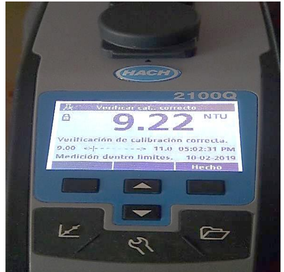
Figura 106: Verificación de calibración para el muestreo de campo por parte del responsable del programa de vigilancia de la calidad del agua para consumo humano-pvica-red de salud Bagua.
