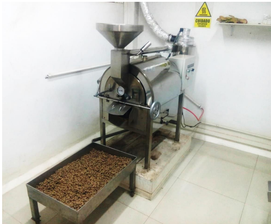
Fotografía 03. Tostado de granos de cacao a 120°C por un total de 30 minutos, la tostadora es de una capacidad de 10kg. por lo que se realizó dos batch de 8kg. cada uno.
