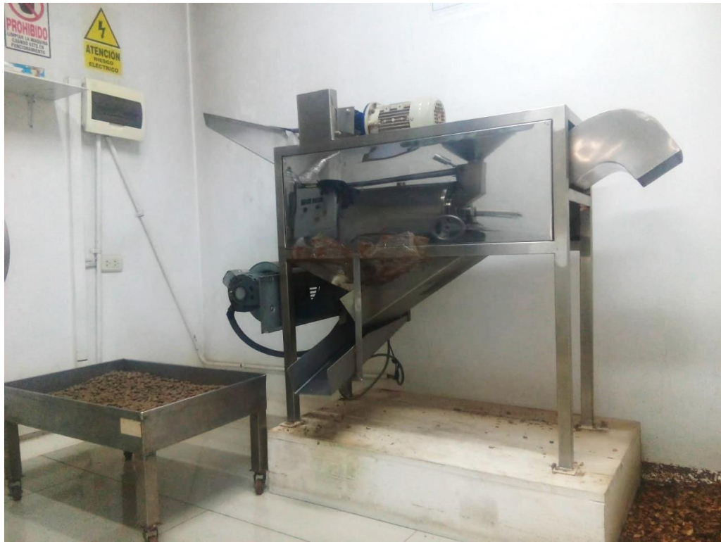
Fotografía 04. Descascarillado de granos de cacao.
