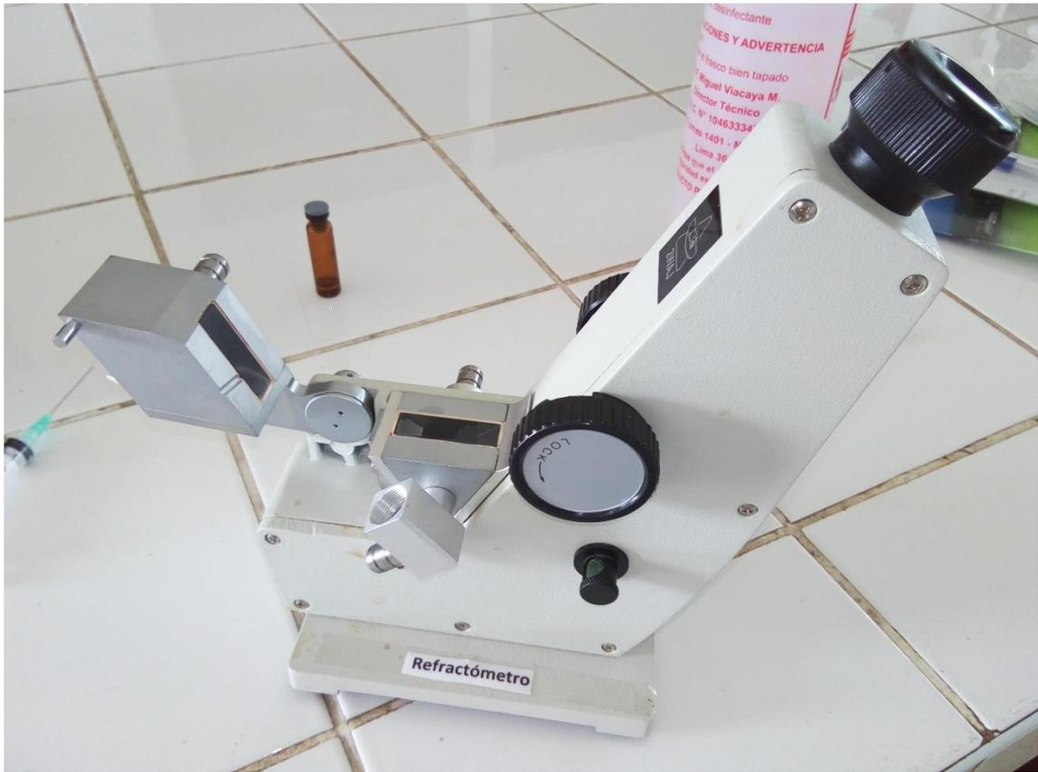
Figura 19. Refractómetro utilizado para la determinación de índice de refracción
