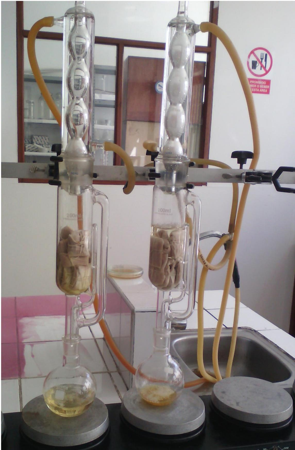
Figura 12. Extracción del aceite usando éter de petróleo, usando la técnica de Soxhlet
