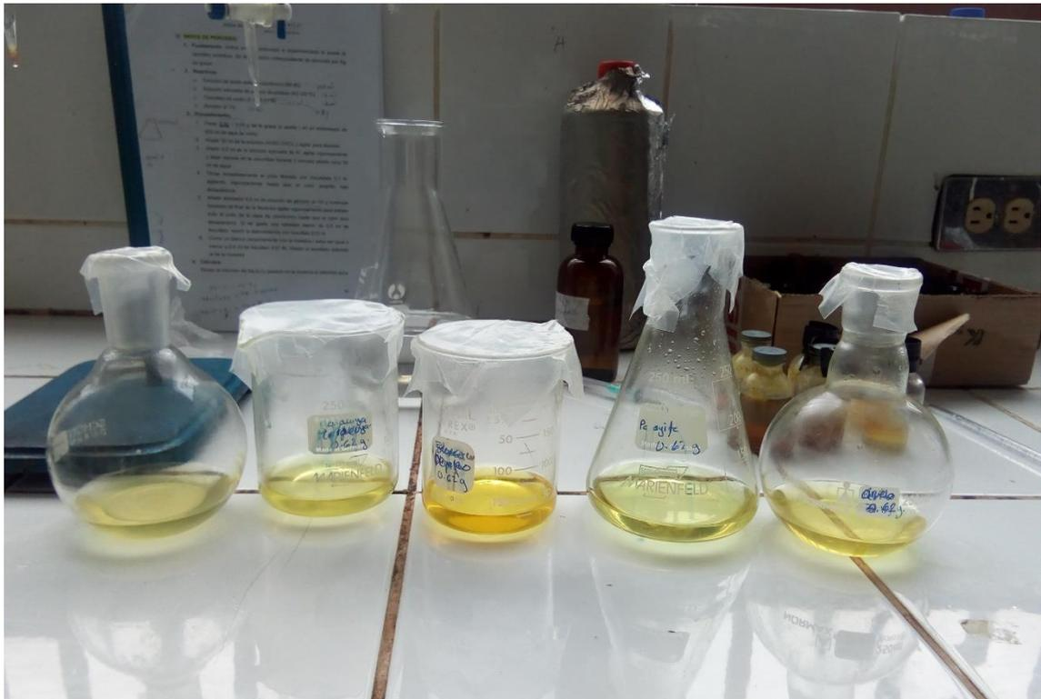
Figura 21. Preparación de las muestras para el análisis de índice de peróxidos
