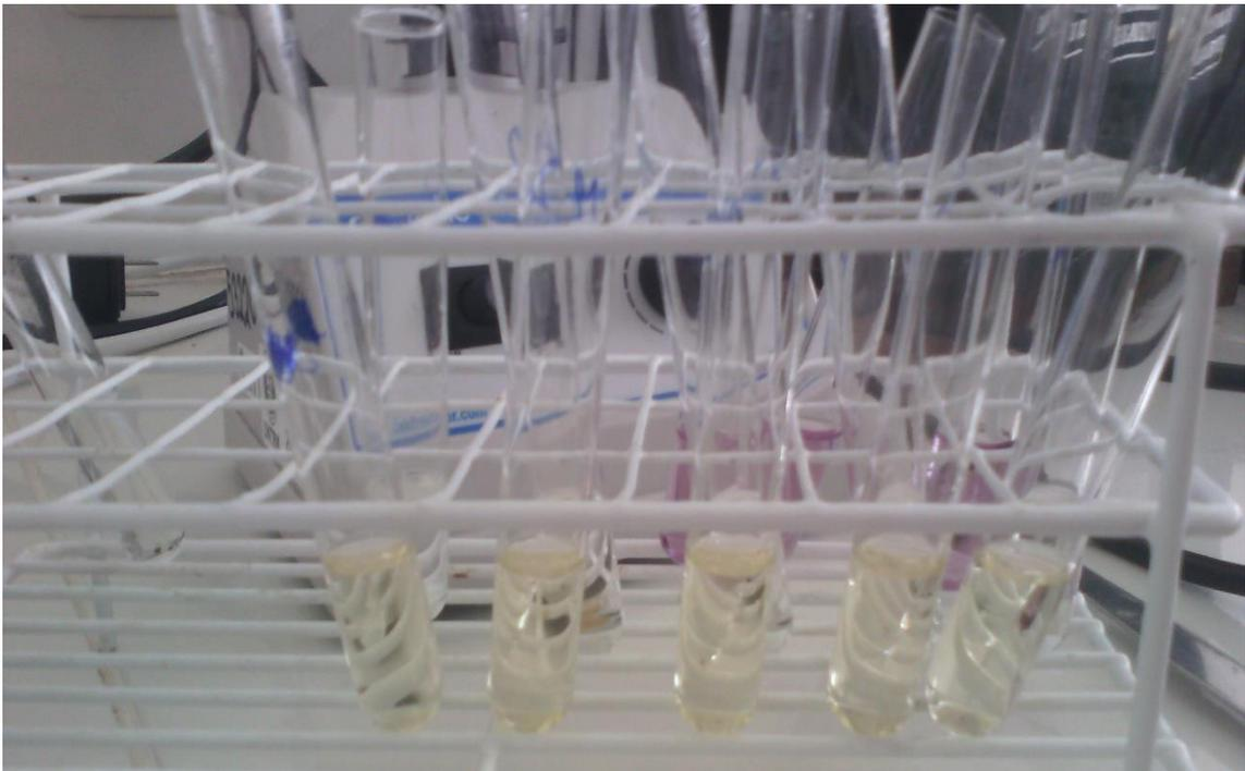
Figura 14. Soluciones preparadas por triplicado por cada muestra para medir la absorbancia en el espectrofotómetro
