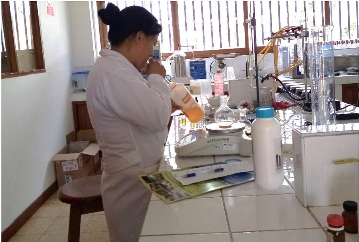
Figura 15. Preparación de las soluciones para medir el índice de saponificación
