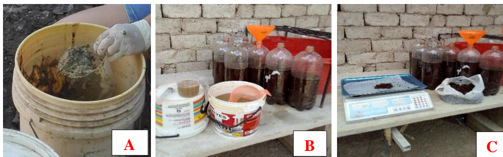
Figura 6. Llenado de los biodigestores de acuerdo a las variables (estiércol de cerdo (A), agua miel (B) y pulpa de café (C)).
