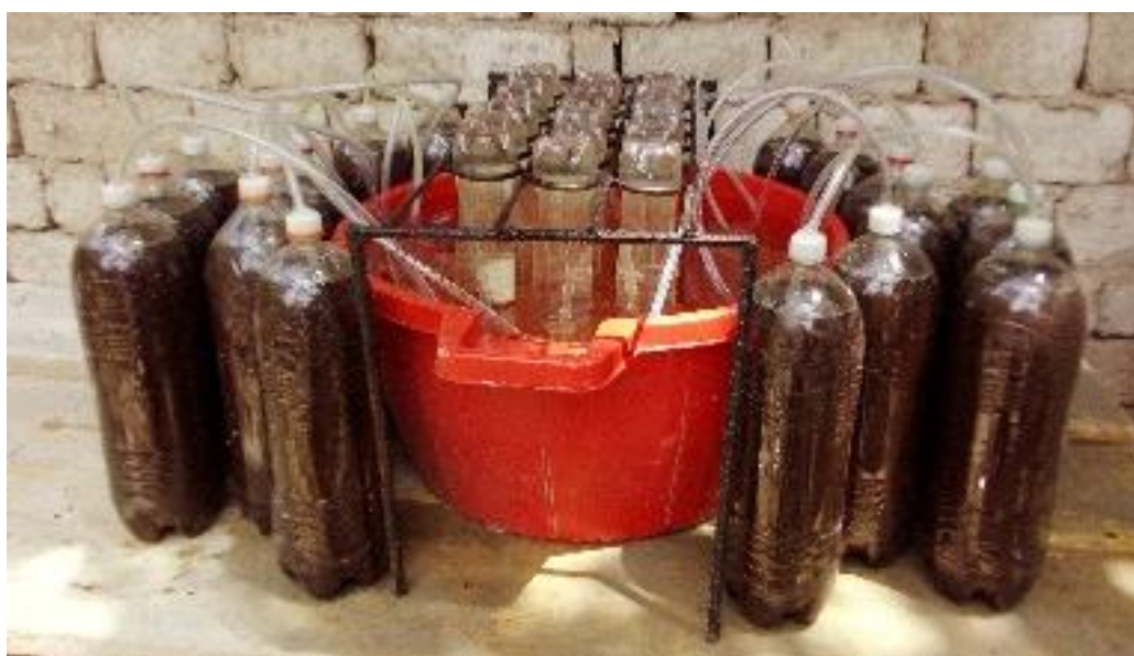
Figura 7. Biodigestores conectados a su respectivo gasómetro.
