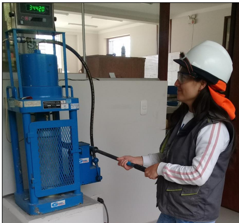
Foto N° 14: Realizando la rotura de probetas.
