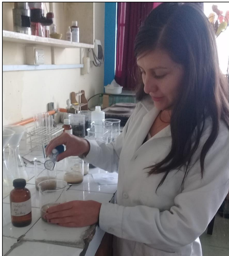
Foto N° 10: Ensayo de durabilidad con sulfato de sodio.
