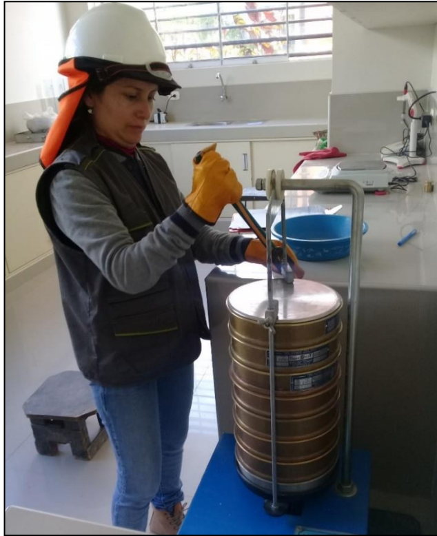
Foto N° 3: Realización de tamizado del material.
