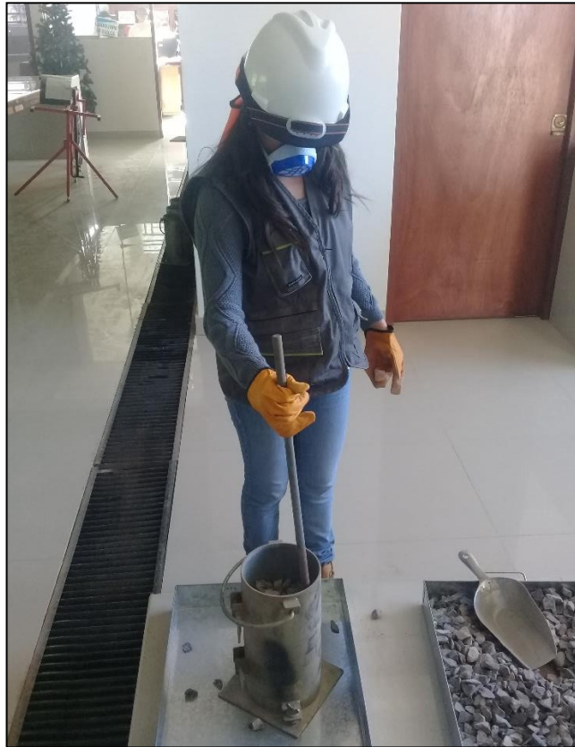
Foto N° 5: Ensayo del peso unitario compactado seco
