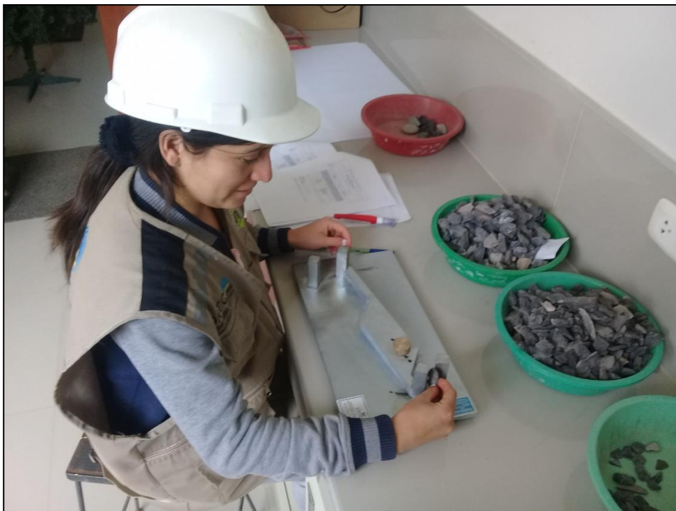
Foto N° 8: Determinando las partículas chatas y alargadas.
