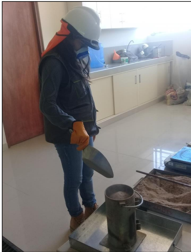
Foto N° 4: Ensayo del peso unitario suelto seco
