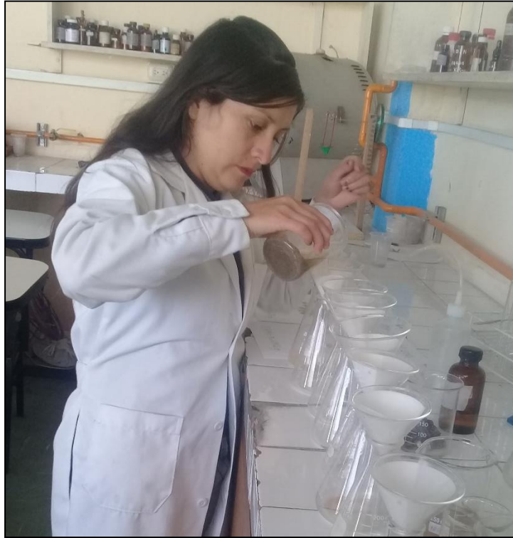
Foto N° 11: Ensayo de reactividad agregado/álcali.
