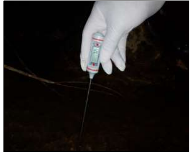
Figura 15. Se calcula la temperatura en los dos puntos de muestreo
