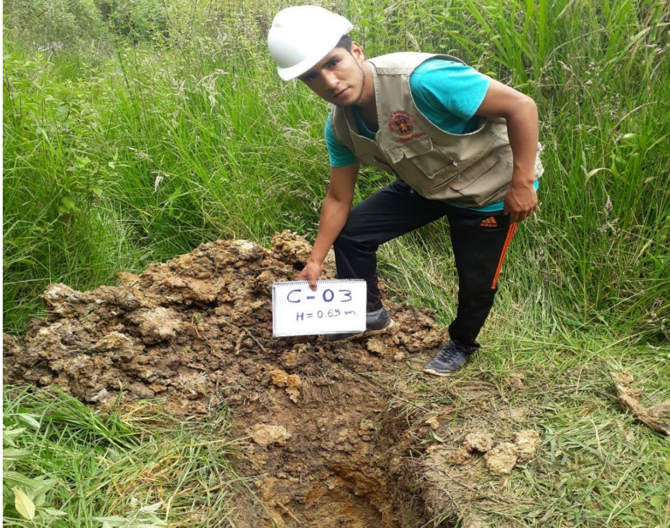
Figura 38. extracción de suelo, para medir niveles de vulnerabilidad física
