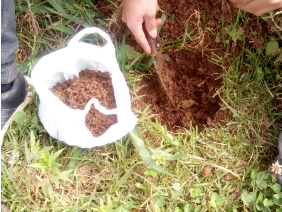
Figura 36. extracción de muestra de suelo para cálculo de coeficiente de escorrentía
