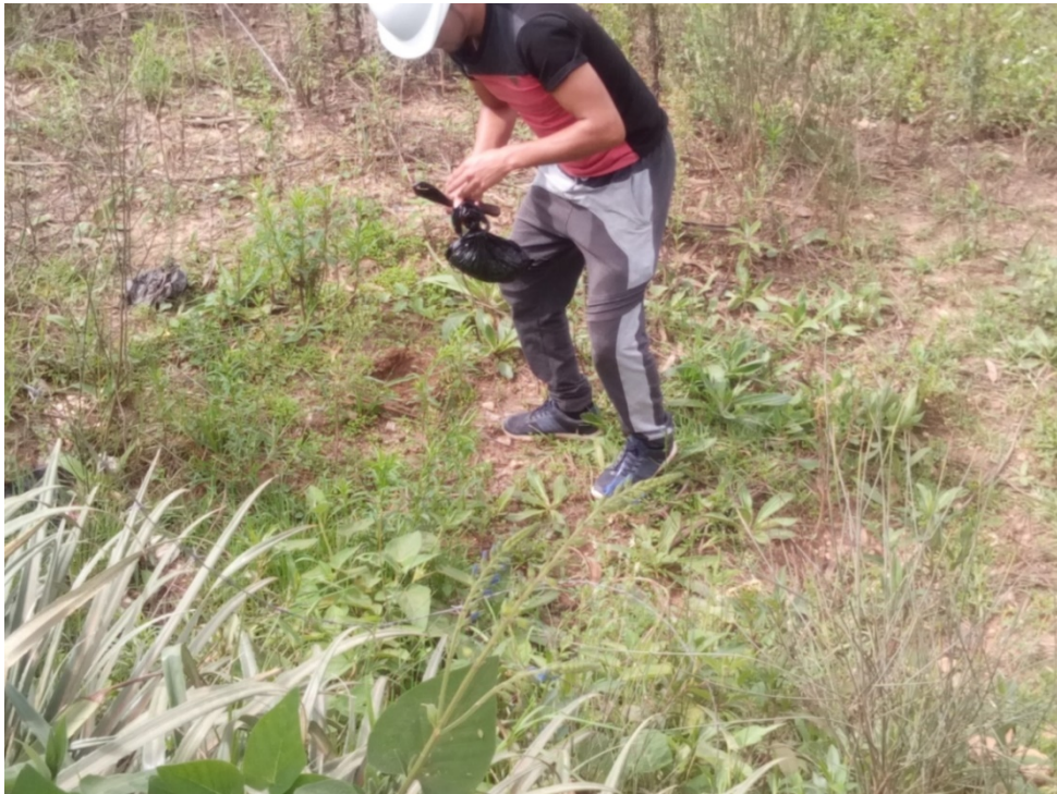
Figura 35. extracción de muestra de suelo para cálculo de coeficiente de escorrentía
