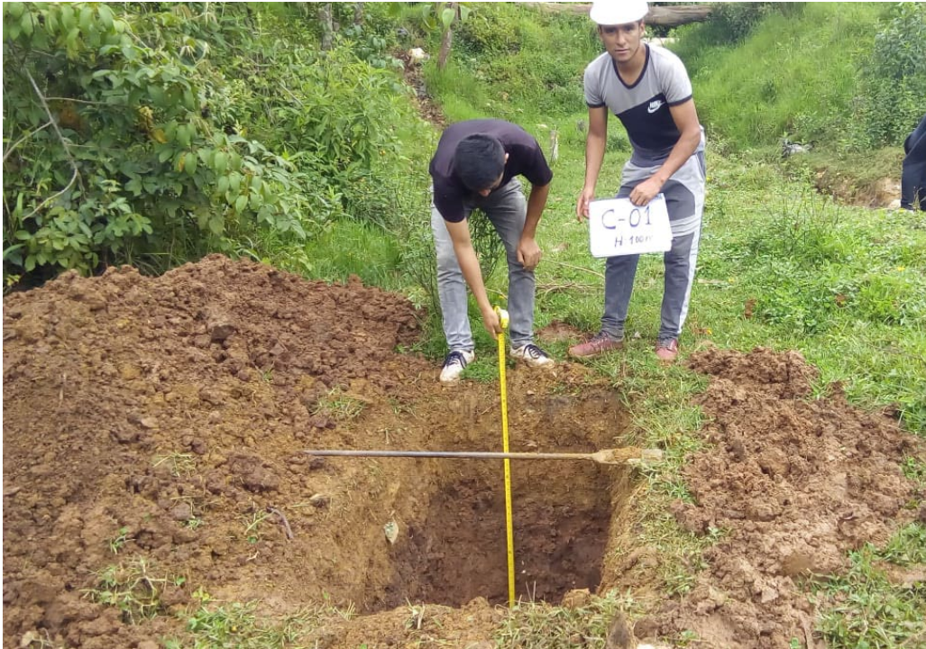
Figura 40. extracción de suelo, para medir niveles de vulnerabilidad física
