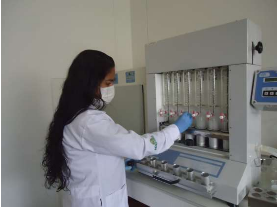
Figura 8. Equipo Soxhlet para la extracción de grasa total.
