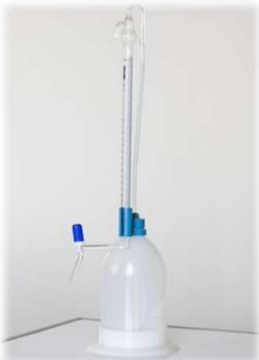
Figura 16. Equipo de titulación para determinar índice de acidez.
