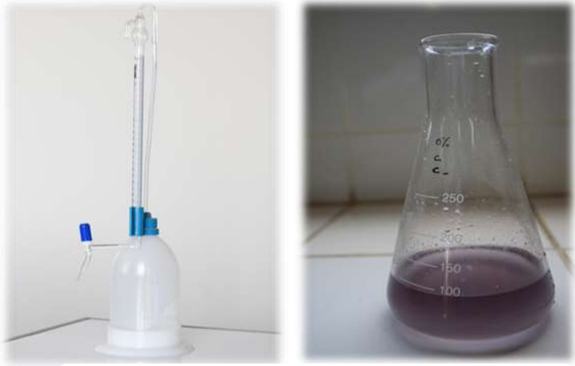
Figuras 21. Determinación de índice de peróxido, mediante titulación
