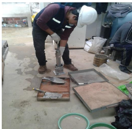
FOTO 7. -Se observa ejecución de ensayo de Proctor.
