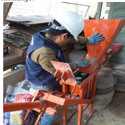
FOTO 18.- Se observa el moldeo de un LTC.
