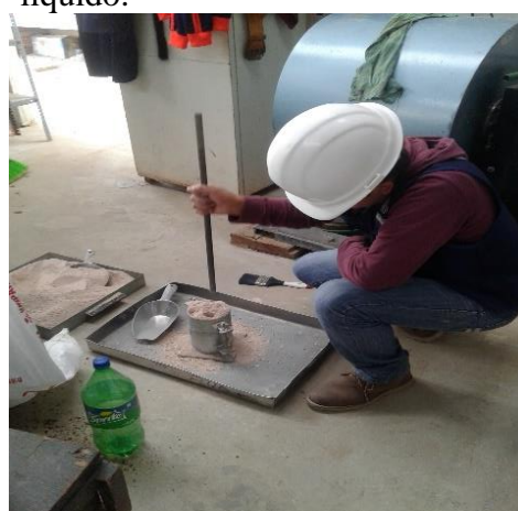
FOTO 10. -Se realiza el ensayo de peso unitario del suelo.
