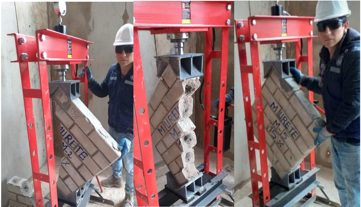
Figura 69. Falla grieta diagonal en muretes de LTC
