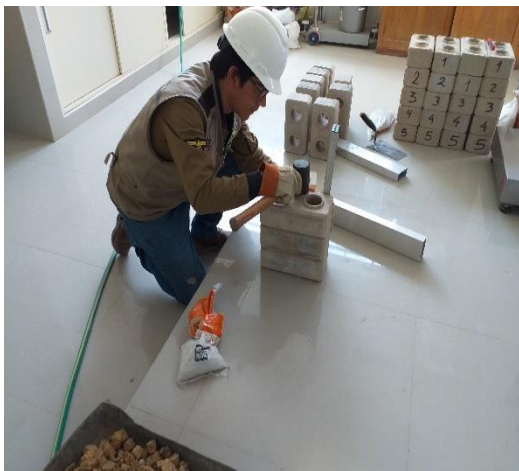
FOTO 21.- Asentado de LTC, en pilas.
