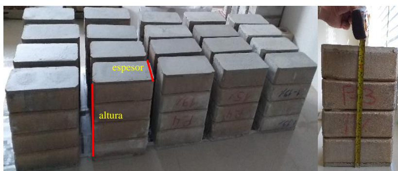
Figura 37. Dimensiones de altura y espesor en pilas de LTC.
