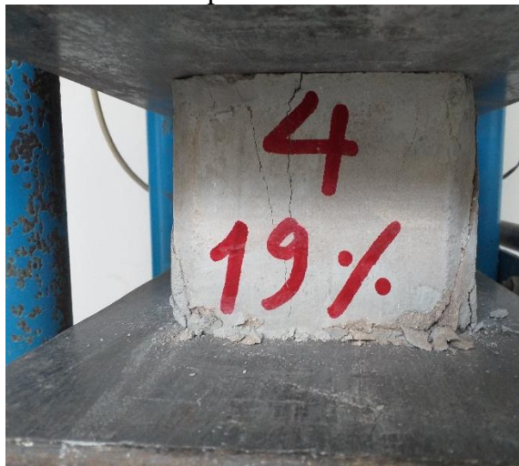
FOTO 28.- En la imagen se observa la compresión de la unidad LTC.
