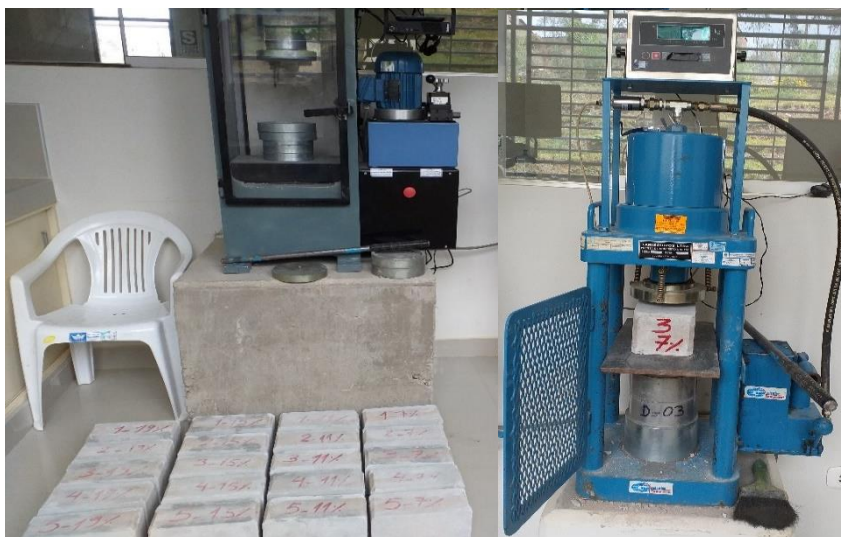
Figura 36. Ensayo de compresión axial de LTC.
