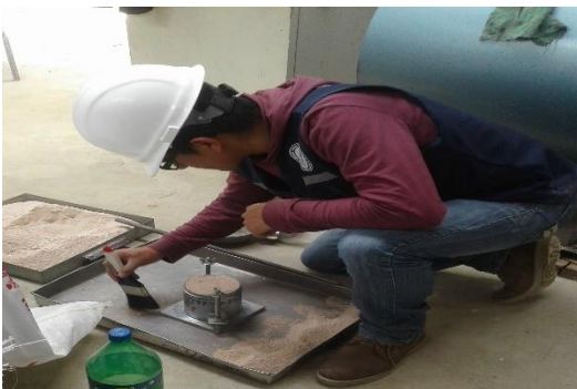
FOTO 5.- Se observa la realización del ensayo de peso unitario en laboratorio SUELOS MTC-CHACHAPOYAS.
