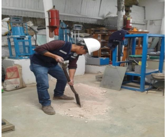
FOTO 4.- Se observa el cuarteo de la muestra en Laboratorio del MTC-CHACHAPOYAS.
