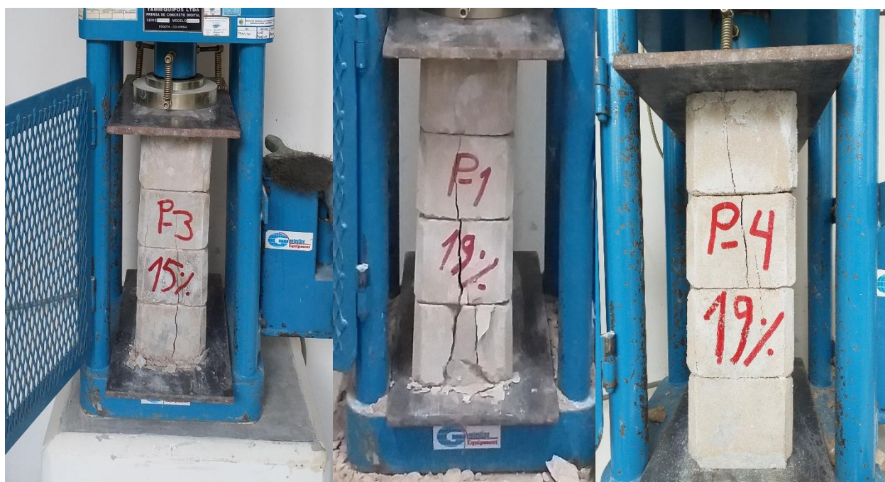
Figura 68. Falla grieta vertical en pilas de LTC
