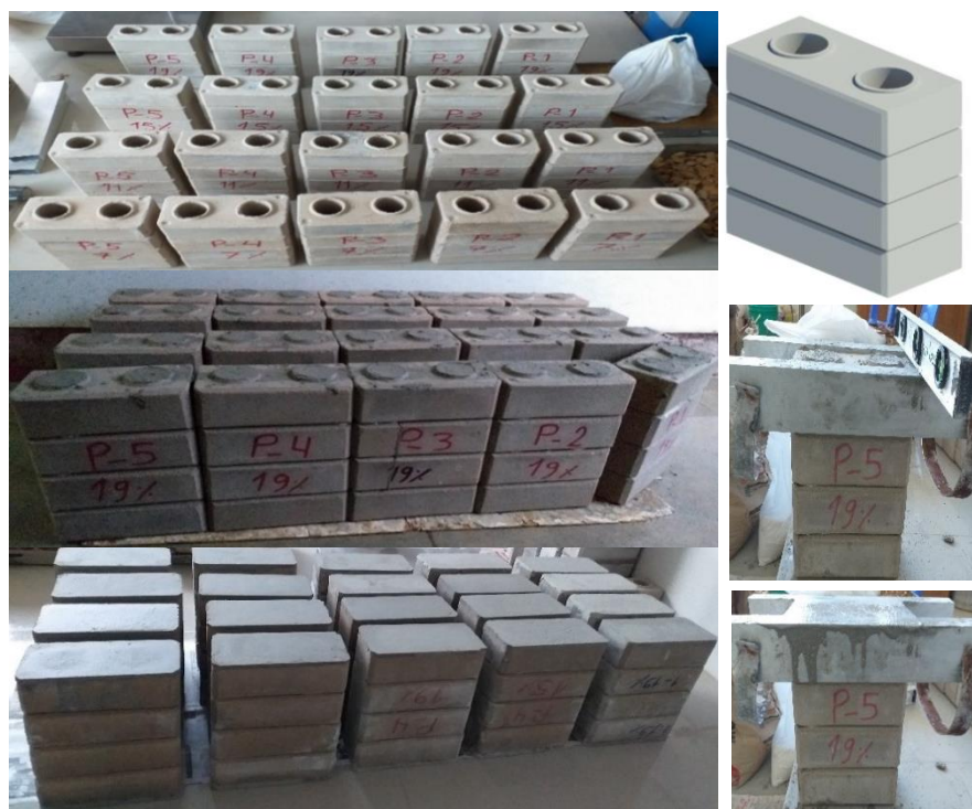
Figura 22. Vista de armado y refrentado de pilas de 4 lotes de LTC.
