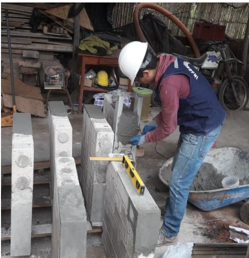
FOTO 27.- En la imagen se observa el refrentado de muretes de LTC.
