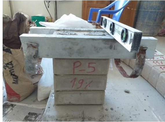
FOTO 26.- En la imagen se observa el refrentado de pilas de LTC.
