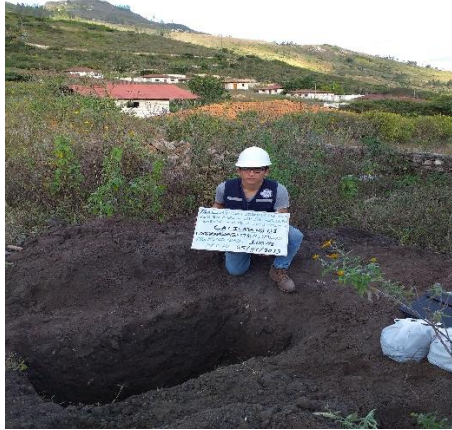
FOTO 13.- En la imagen se observa la calicata C-1.
