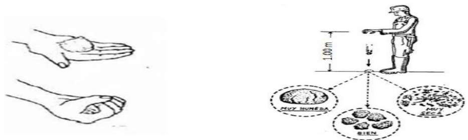
Figura 17. Prueba de humedad óptima, tomada de Abanto Flores y Akarley Poma, 2014.
