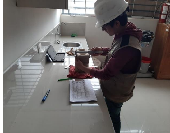
FOTO 20.- Se está realizando el ensayo de variabilidad de dimensiones.
