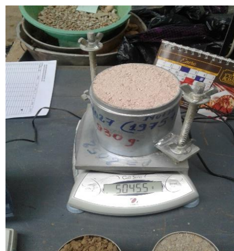
FOTO 12. -Se observa la muestra enrasada para ser pesada.
