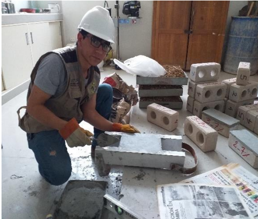
FOTO 25.- En la imagen se observa el refrentado de unidades de LTC.
