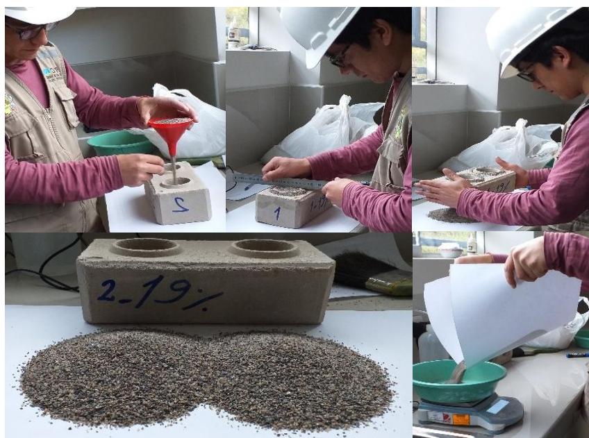
Figura 35. Ensayo de % de área de vacíos de LTC.
