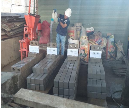
FOTO 19.- En la imagen se observa el curado de LTC.
