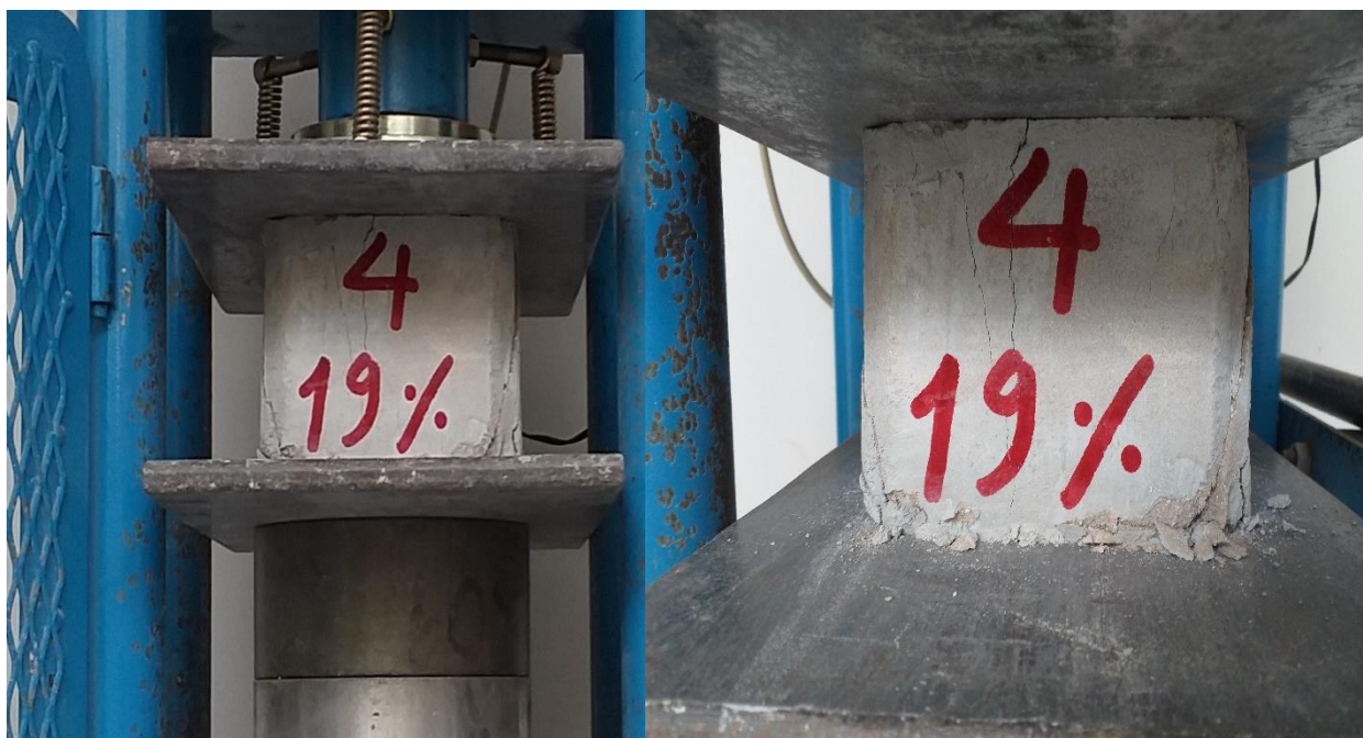
Figura 67. Falla grieta vertical en unidades de LTC
