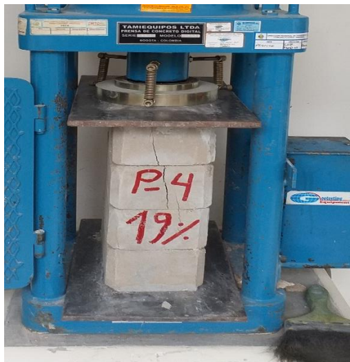
FOTO 29.- En la imagen se observa la compresión de pilas de LTC.
