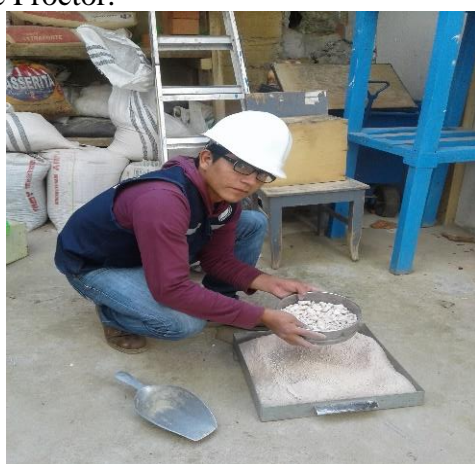
FOTO 9. -Preparacion de muestra pasando por la malla N° 4 para realizar el ensayo de peso unitario.
