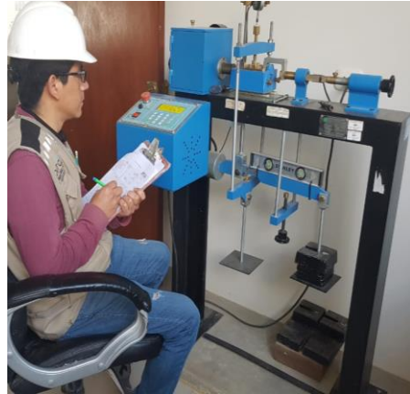
FOTO 14.- Se está realizando el ensayo de corte directo.
