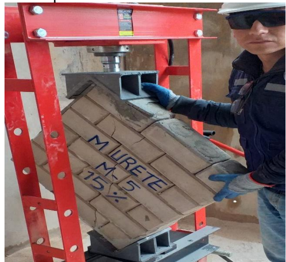
FOTO 30.- En la imagen se observa la compresión de muretes de LTC.
