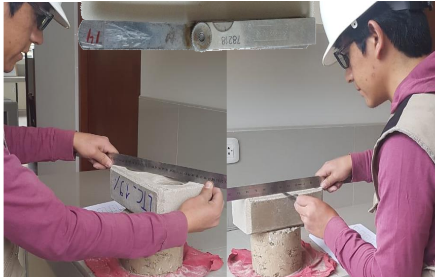
Figura 30. Medición de concavidad y convexidad.
