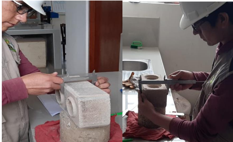
Figura 28. Medición de aristas de LTC, con vernier.
