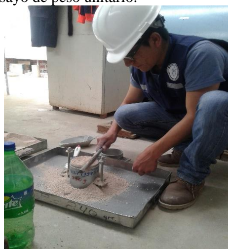
FOTO 11. -Se procede a enrasar la muestra tal como se observa en la imagen.
