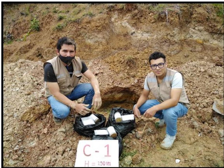
Fotografía 02: Se observa las muestras extraídas de cada uno de los estratos para ser ensayadas en el laboratorio de mecánica de suelos.
