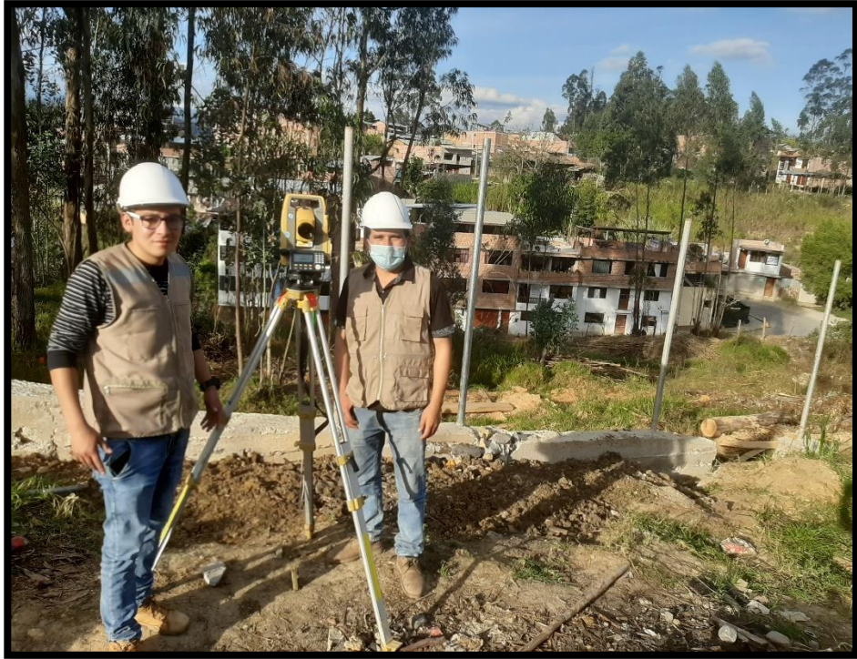
Fotografía 06: Se observa la puesta en estación de la estación total ES 105 para realizar la lectura de puntos topográficos.
