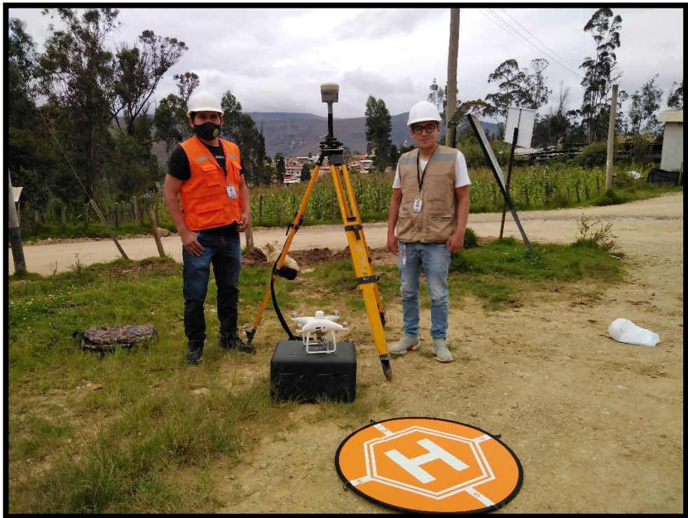
Fotografía 09: Se observa la puesta en estación del DRON para realizar las tomas de imágenes aéreas
