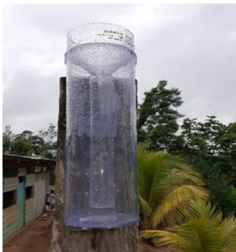
5. Instalación del pluviómetro
