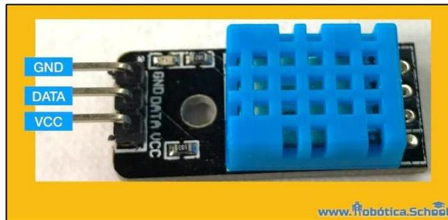
**Figura 12.** Sensor de Arduino de Temperatura y Humedad KY015 DTH11, Tomada de Robotica.School <https://www.robotica.school>
