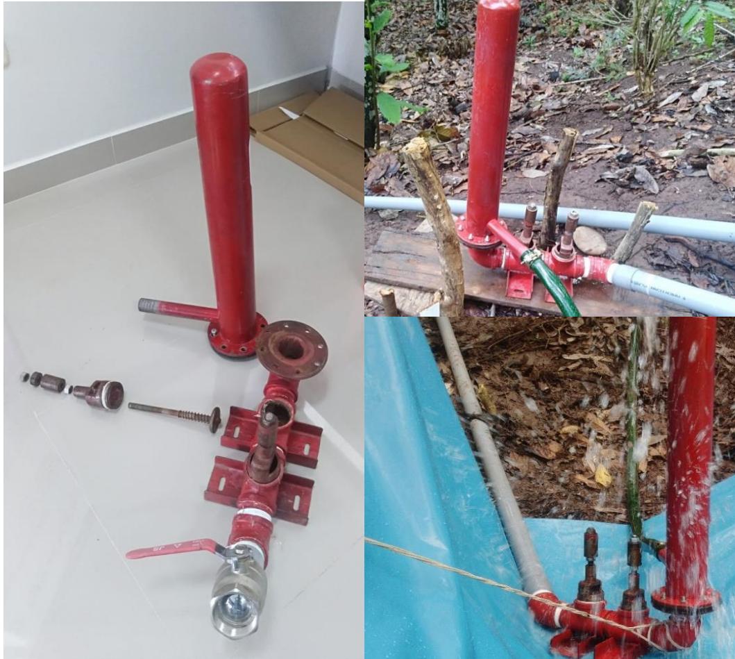
Figura 6. Bomba de ariete hidráulico con dos válvulas de impulso, desmontada e instalada.
