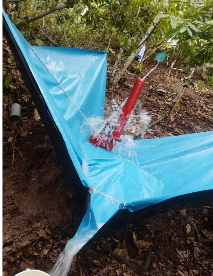
Fotografía 3. Tubería de alimentación, derrame y descarga.
