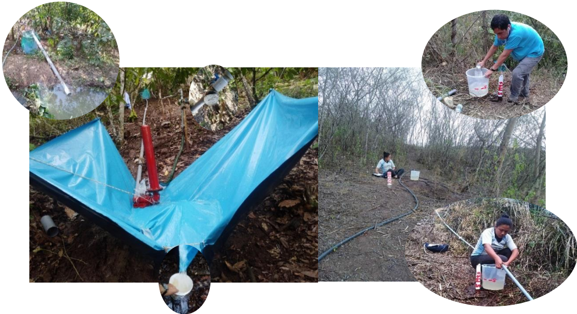
Figura 15. El tanque de alimentación se encuentra en la parte superior izquierda, la bomba de ariete en la parte izquierda, en la parte inferior se muestra la medida de agua perdida, en la parte derecha se muestra el sistema de tuberías y las mediciones según alturas evaluadas.
