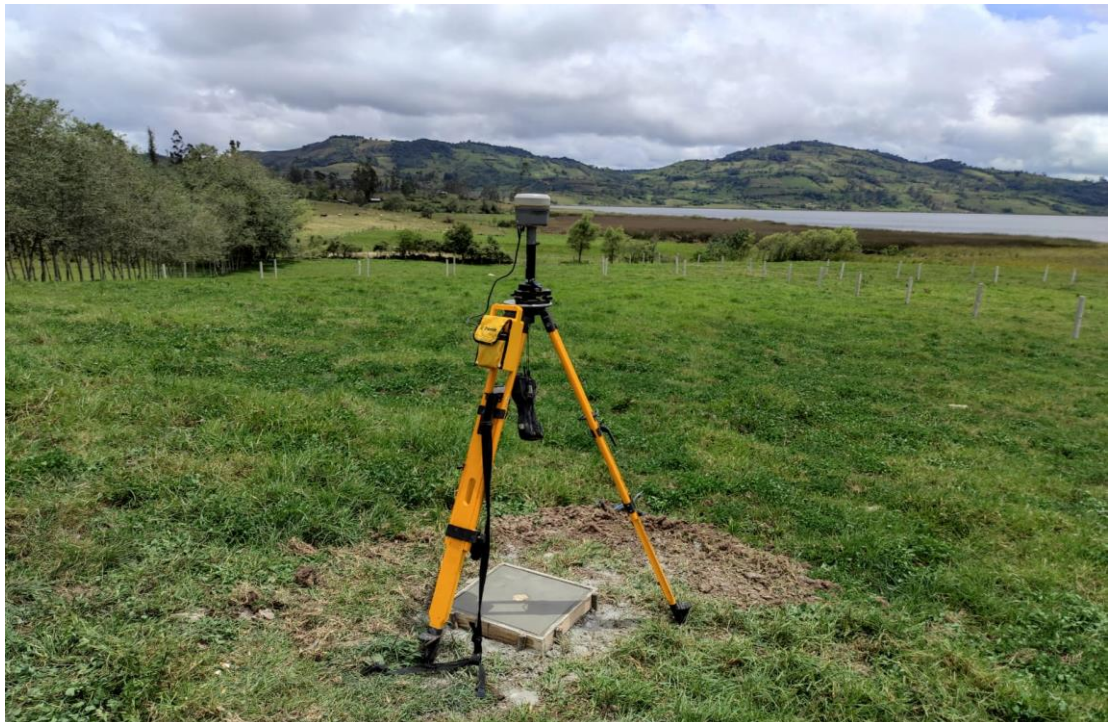
Fotografía 06: Punto geodésico de orden C, monumentado en el Lago Pomacochas
