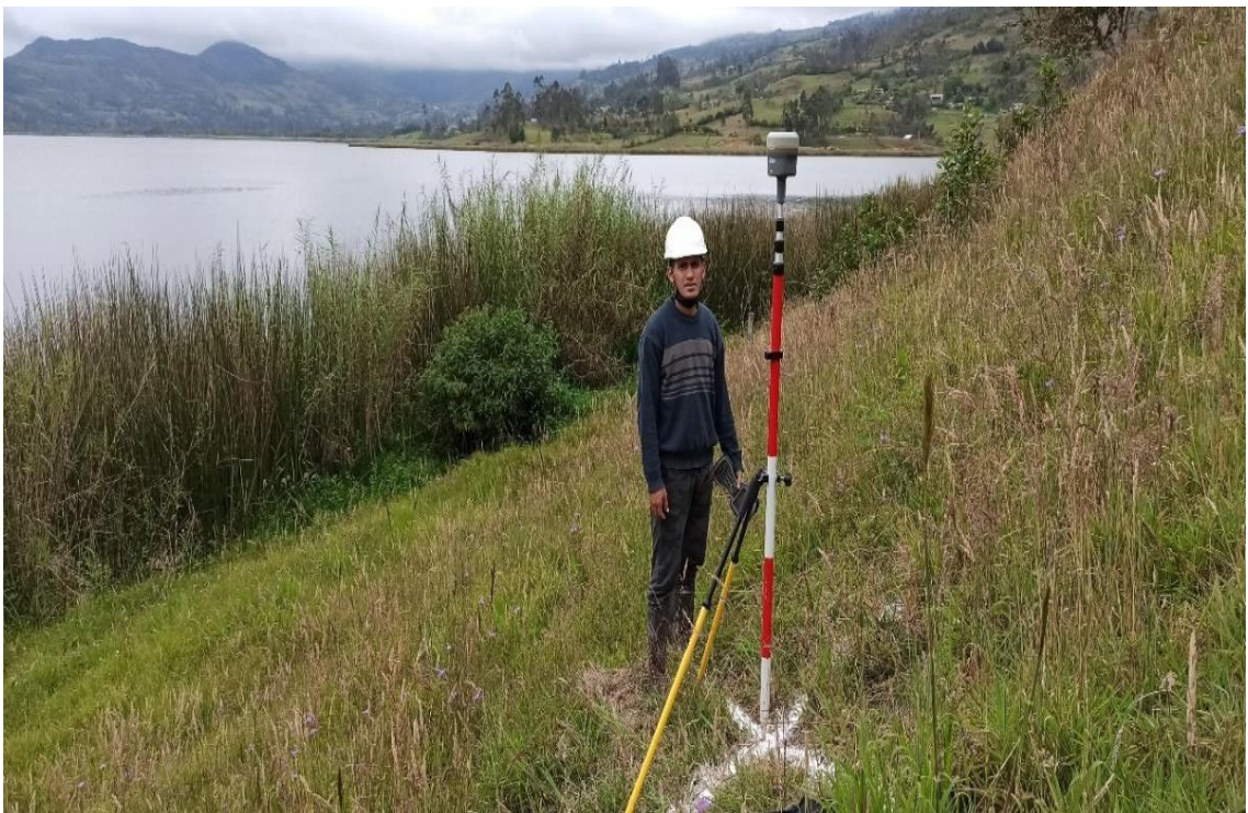
Fotografía 08: Medición de puntos de control terrestre para el vuelo fotogramétrico realizado sobre el Lago Pomacochas.
