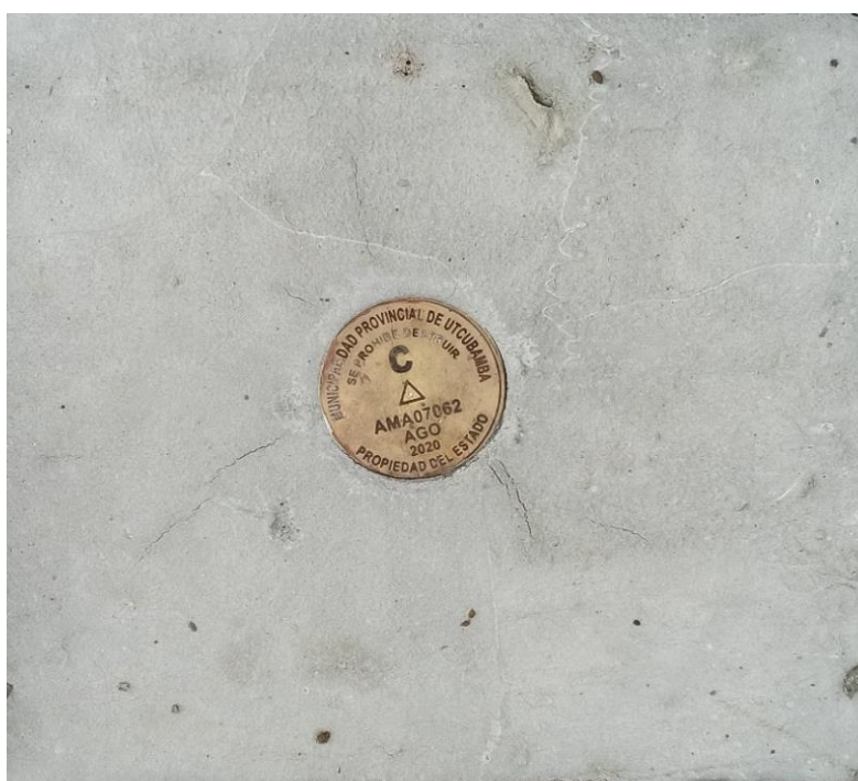
Fotografía 01: Punto geodésico de orden C, monumentado en el Lago Burlán.
