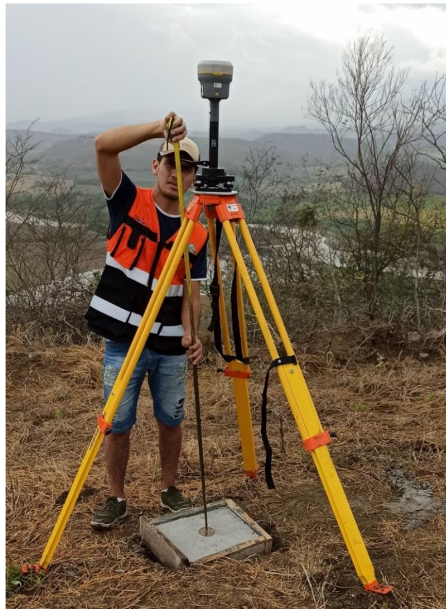
Fotografía 02: Medición de coordenadas sobre el punto C utilizando el receptor GNSS Trimble R10, para el Lago Burlán.
