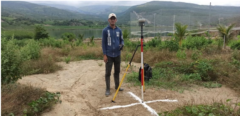
Fotografía 04: Medición de puntos de control terrestre para el vuelo fotogramétrico realizado sobre el Lago Burlán
