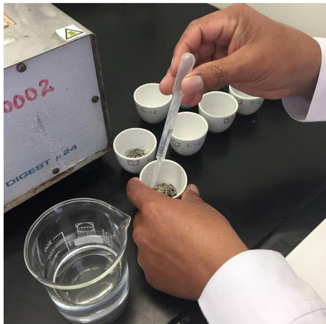
**Anexo 1.16. Agregando el ácido clohidrico**
