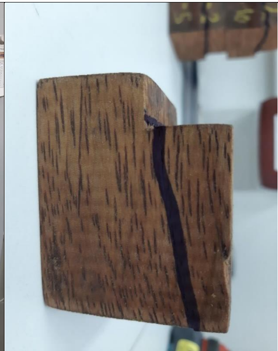
Foto 42: Señalizado de falla, de probeta sometida a cizallamiento.
