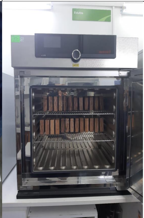
Foto 36: Proceso de secado al horno de las probetas para obtener el estado Anhidrido.
