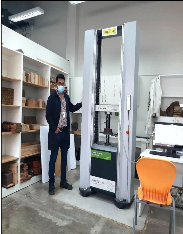
Foto 29: Máquina universal, propiedad del laboratorio CITEMadera, sede Lima.
