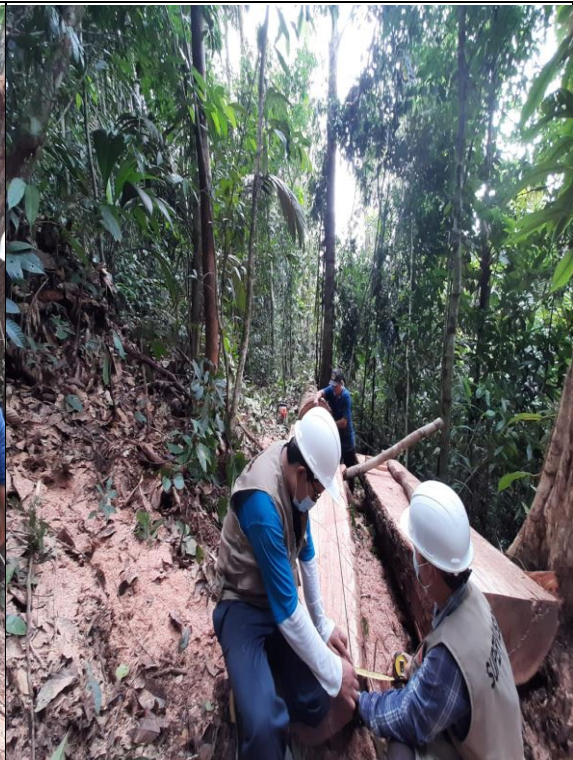
Foto 10: Trazado de tablonces de 3" y 4" para fácil transporte del bosque a caserío.
