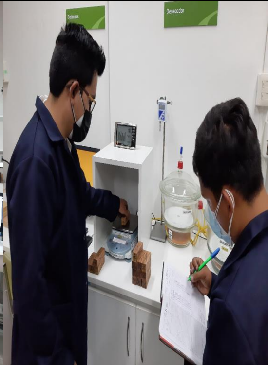
Foto 30: Toma de pesos de probetas para los ensayos físicos, contenido de humedad, densidad y contracción.
