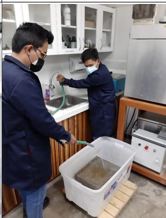
Foto 32: Llenado de depósitos hasta sumergir en su totalidad a las probetas.
