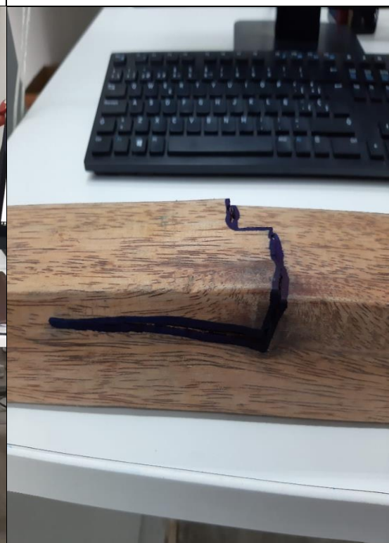
Foto 40: Señalizado de la falla, en el ensayo mecánico de flexión estática.
