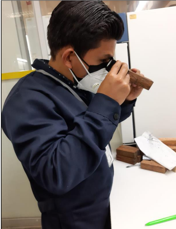
Foto 33: Identificación de cara radial y tangencial de las probetas, para el ensayo físico de contracción.
