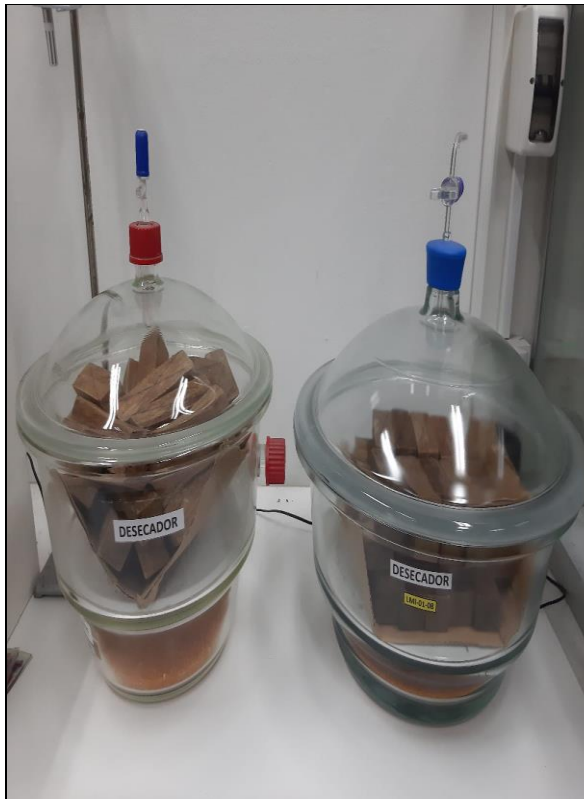
Foto 37: Proceso de enfriamiento en campanas desecadoras de vidrio.
