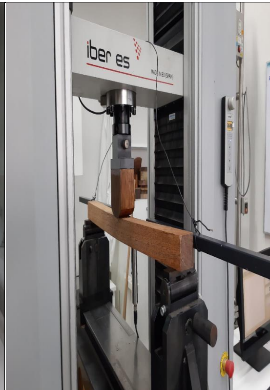
Foto 38: Probeta sometido a flexión en la Maquina Universal.
