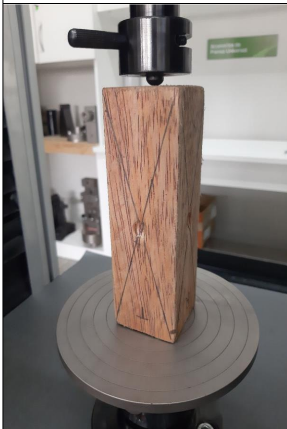
Foto 43: Probeta sometido a compresión perpendicular a la fibra.
