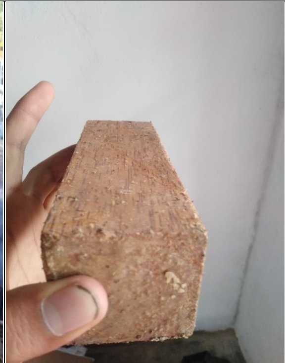
Foto 26: Superficie de grasa de vacuno en probeta, por el método de pincelado.
