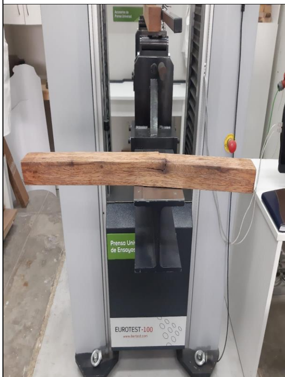
Foto 39: Probeta en su punto de rotura luego de haber sido sometido a flexión.
