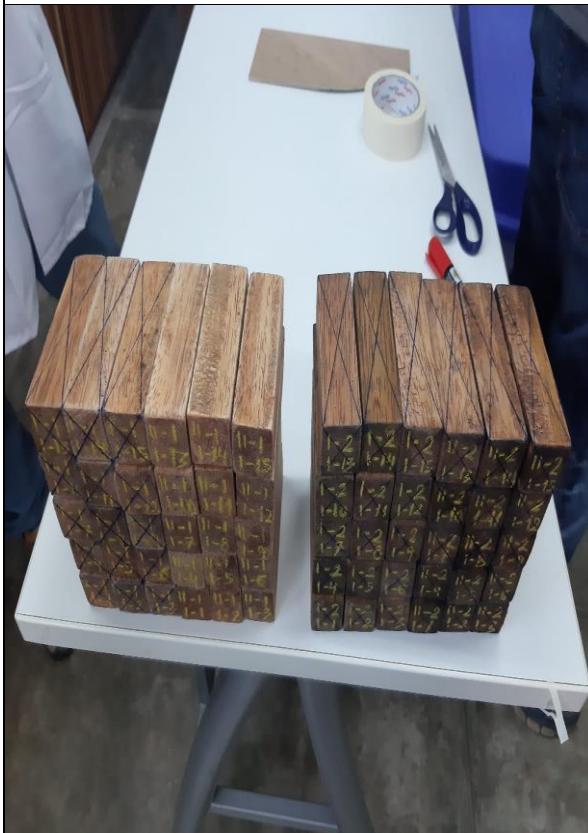
Foto 35: Señalización del punto medio de las caras, de las probetas a ensayar.
