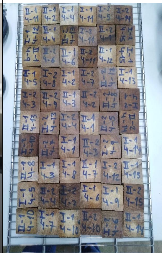
Foto 44: Muestras para contenido de humedad, extraídos de las probetas que fueron sometidos a compresión paralela a la fibra.
