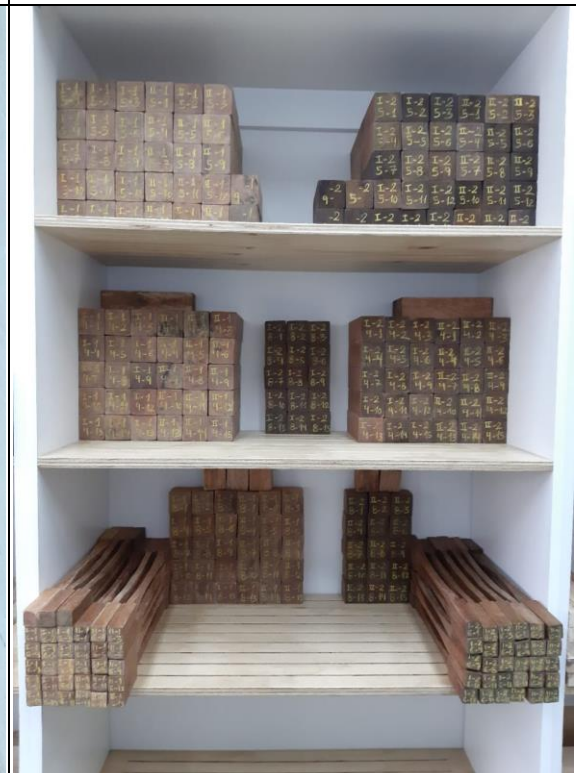
Foto 28: Habilitación y codificación de probetas en el laboratorio CITEmadera, sede Lima.
