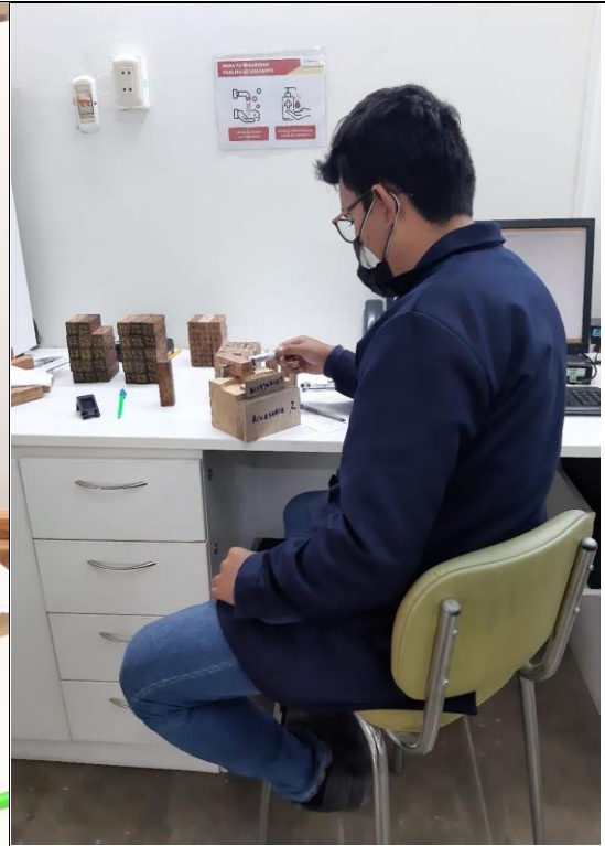
Foto 34: Toma de medidas de ancho, espesor y longitud de las probetas, con la herramienta micrómetro.
