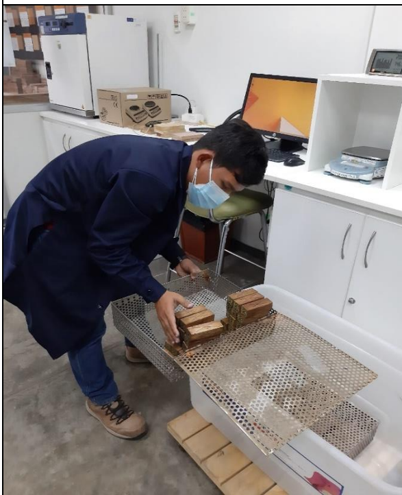
Foto 31: Acondicionamiento de probetas para ser sumergidas en agua.
