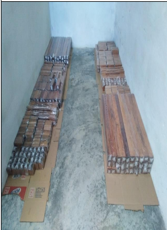
Foto 27: Embalado de probetas con cinta plástica para su transporte a la ciudad de Lima.
