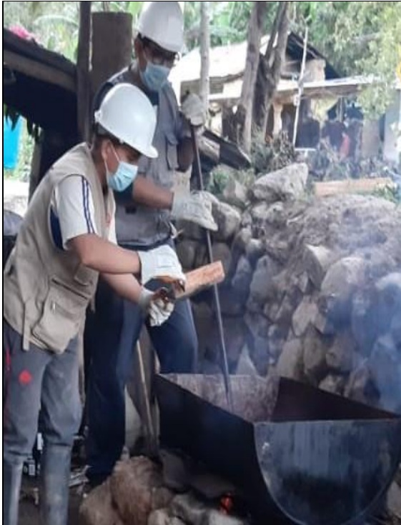
Foto 25: Curado de probetas con grasa de vacuno.
