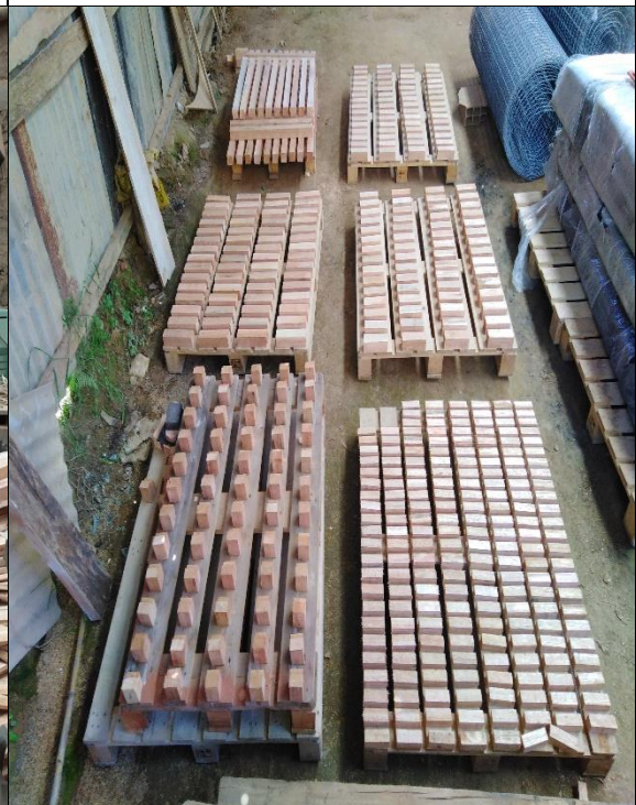
Foto 24: Habilitación de probetas para su curado con grasa de vacuno.
