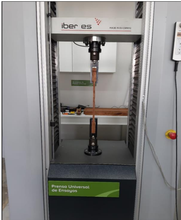
Foto 41: Probeta sometida a Tracción paralela a las fibras.
