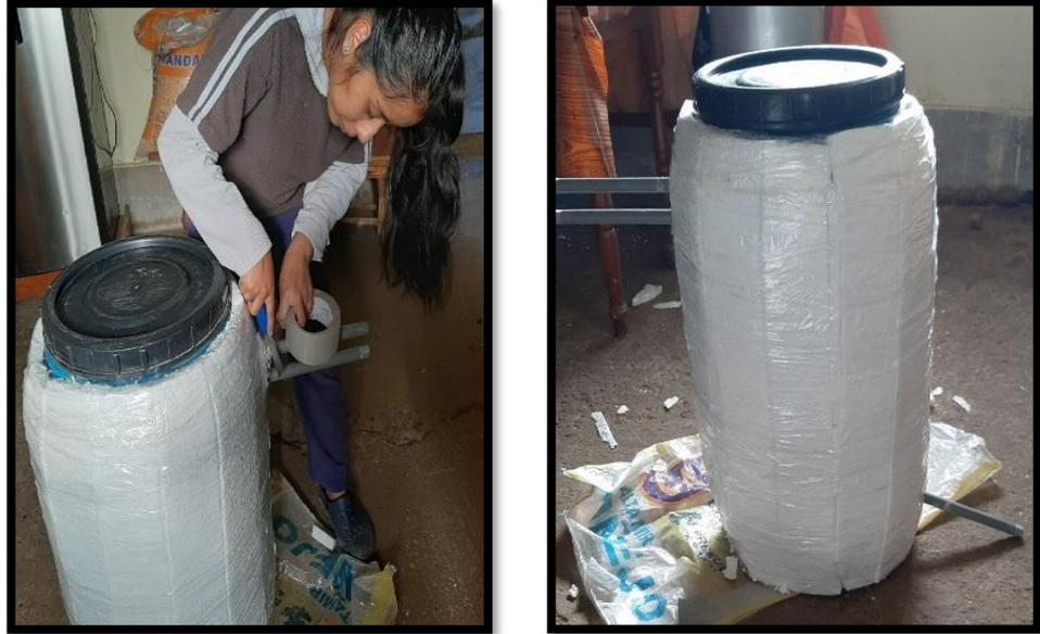
**Figura 10.** *Forrado del tanque de almacenamiento.*
