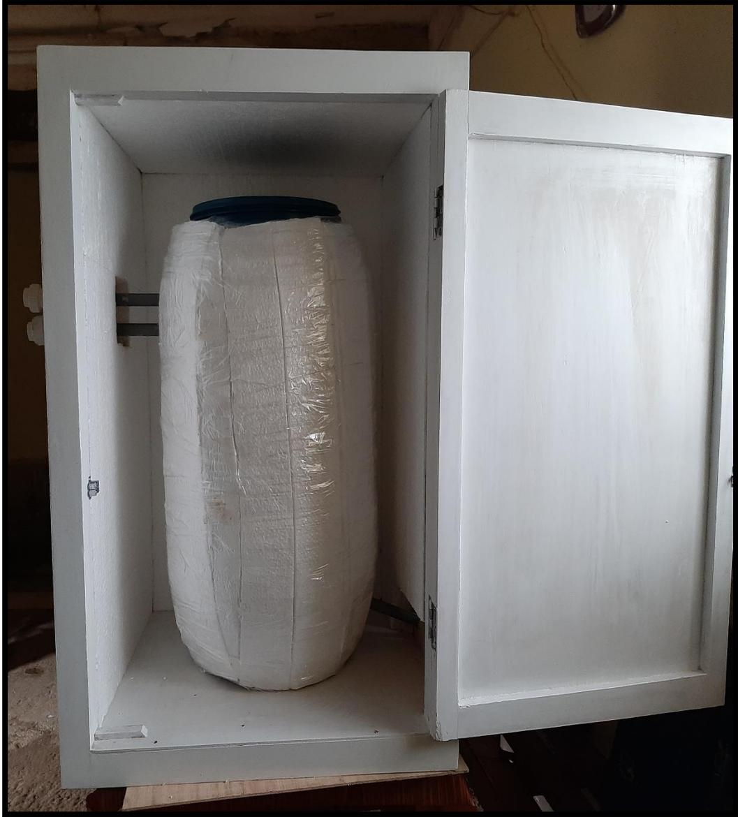
**Figura 13.** *Caja del tanque.*
