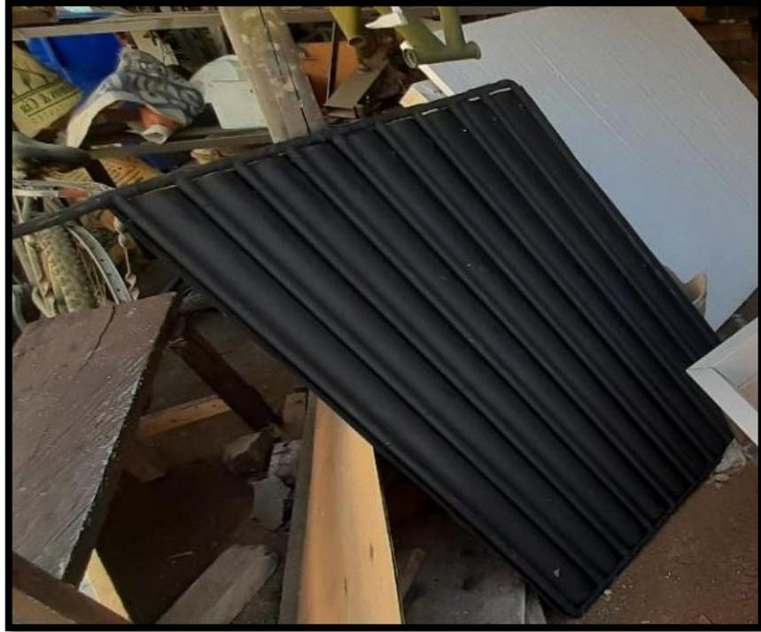
**Figura 5.** *Plancha metálica fijada en la parrilla de tubos del colector.*
