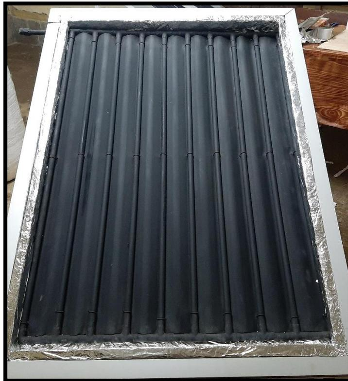
**Figura 6.** Armado de la caja del colector.
