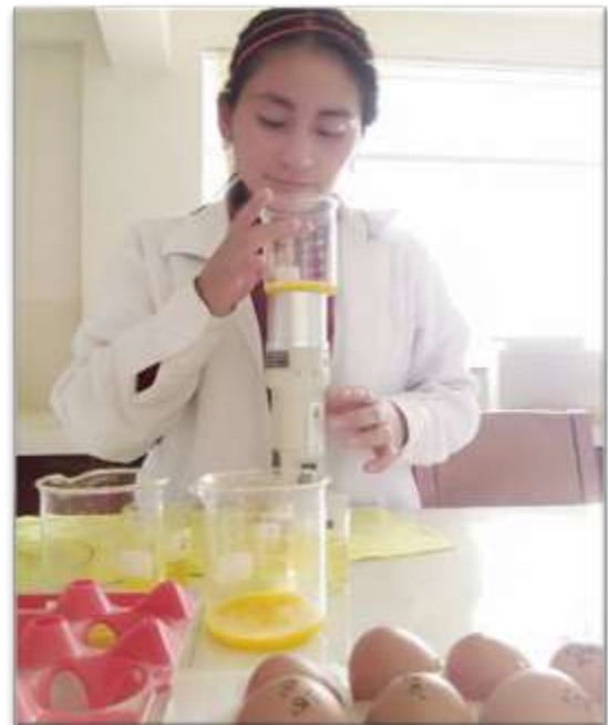
Imagen 15. Medición del color de yema, con un colorímetro CR - 400.
