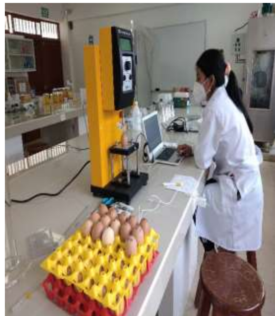
Imagen 11. Medida de la resistencia del huevo haciendo uso de un texturometro.
