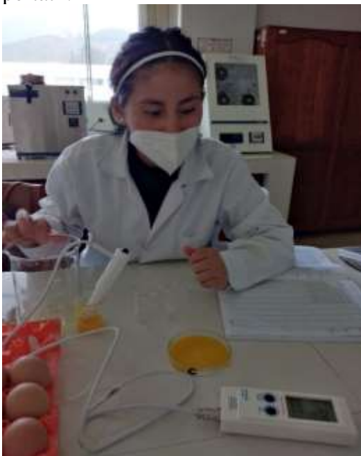
Imagen 18. Medida del pH de la yema y albúmen, con un analizador de pH/ion portátil.
