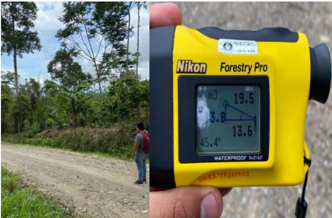
**Fotografía N°12:** Toma de medidas de altura total, altura comercial con el equipo hipsómetro láser.
