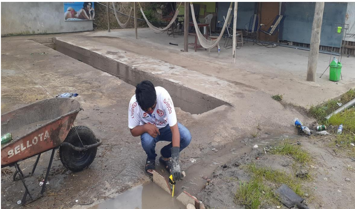
Fotografía 01: Medición de caudal mediante el método del vertedero triangular.
