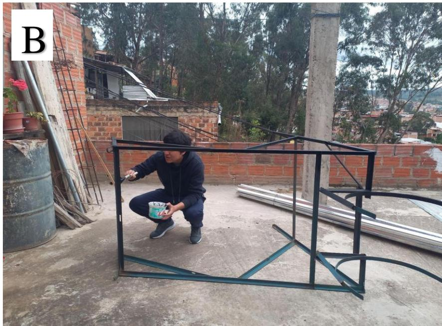
**Figura 8.** (A) Dimensiones del soporte del colector (B) Lijado y pintado del soporte
