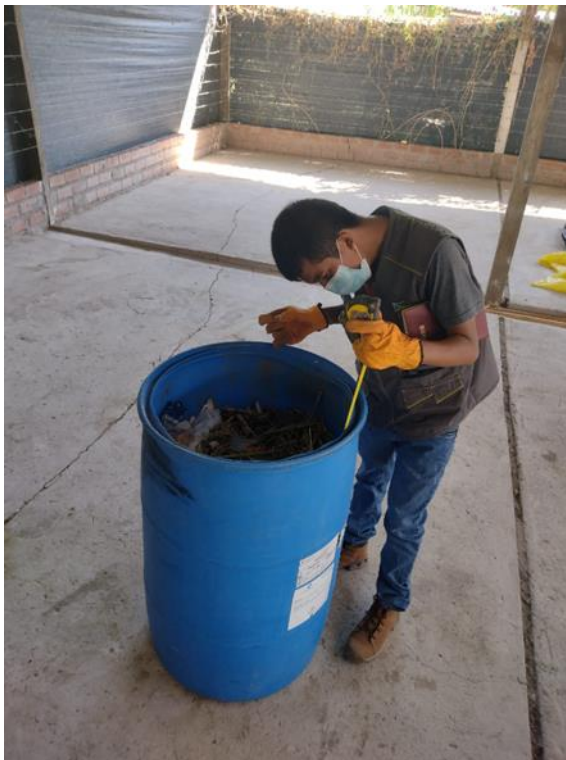
Fotografía 10. Toma de la medida de la altura libre del cilindro para la obtención del volumen.
