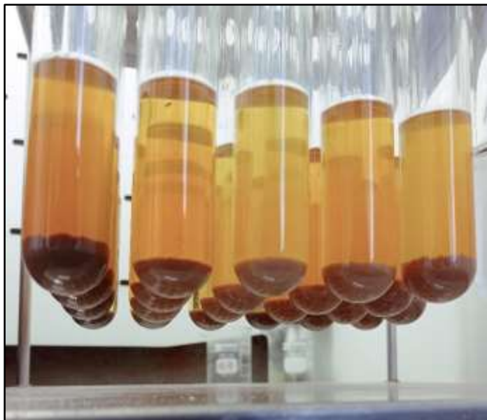
Figura 13. Digestión de muestras de suelo para determinación de la concentración total de elementos traza.
