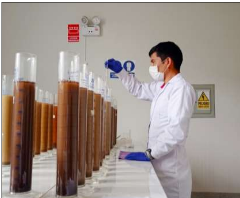
Figura 9. Determinación de textura en de los suelos de cultivo de papa.
