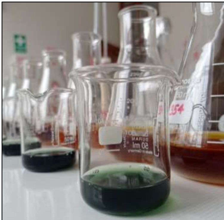
Figura 12. Determinación de materia orgánica en muestras de suelos.
