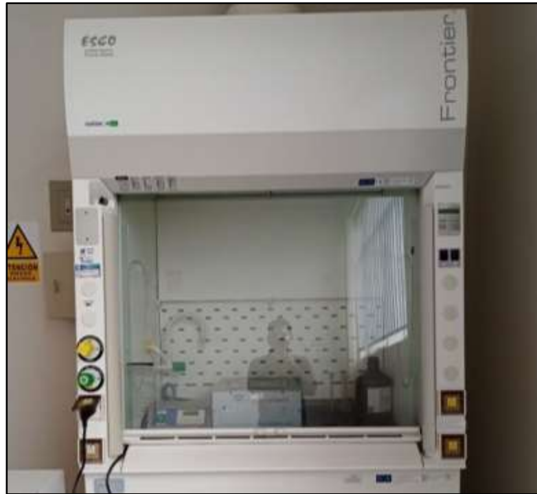
Campana extractora de gases tóxicos marca ESCO.
