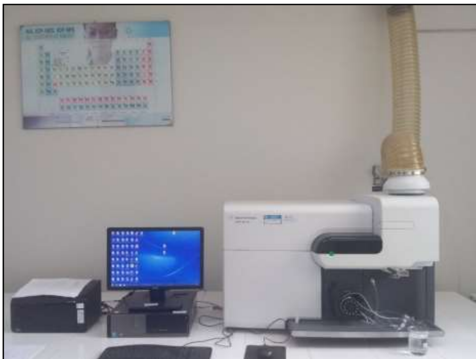
Espectrómetro de emisión atómica de plasma por microondas (MP-AES), LABISAG, INDES-CES, UNTRM.
