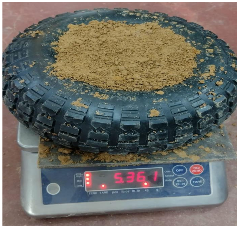
Figura 12. Peso de la muestra de un neumático, para determinar la resistencia a compresión.
