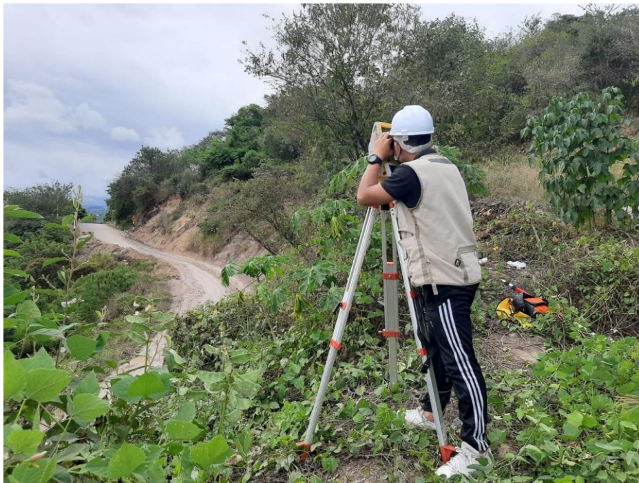
Figura 7. Manejo del equipo Topográfico Estación Total South.
