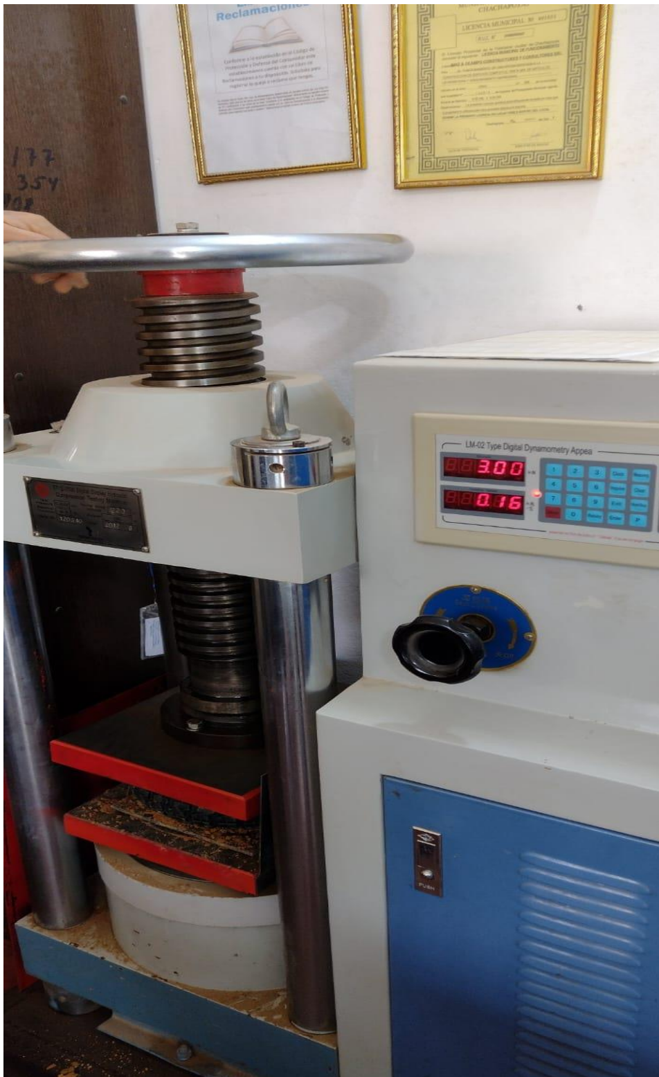
Figura 13. Ensayo para determinar el valor de la resistencia a la compresión
