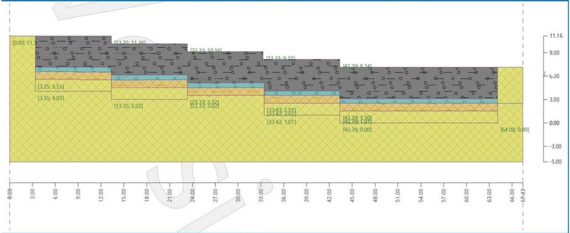
Figura 5. Vista frontal analizado en el software GEO5, de todo el tramo con muro de neumáticos.
