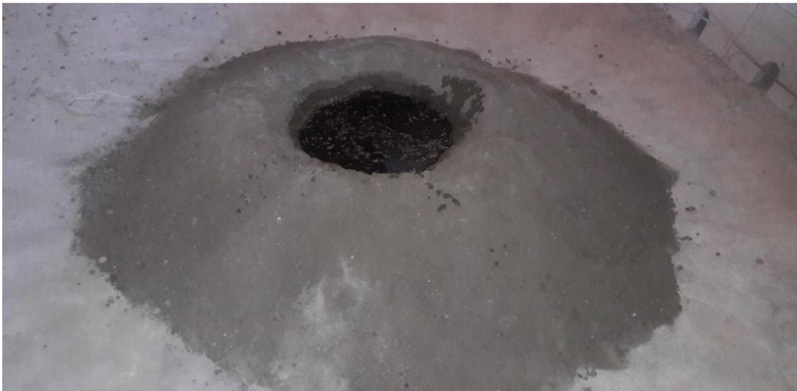
**Paso 3:** Obtenida la mezcla se procedió a llenar el concreto dentro del molde metálico colocado la mezcla a golpe; el método de llenado se realizó golpeando y con una regla metálica se presionó para que se puede acomodar la mezcla, luego se retira el molde de en el área de fraguado y posteriormente curado.
